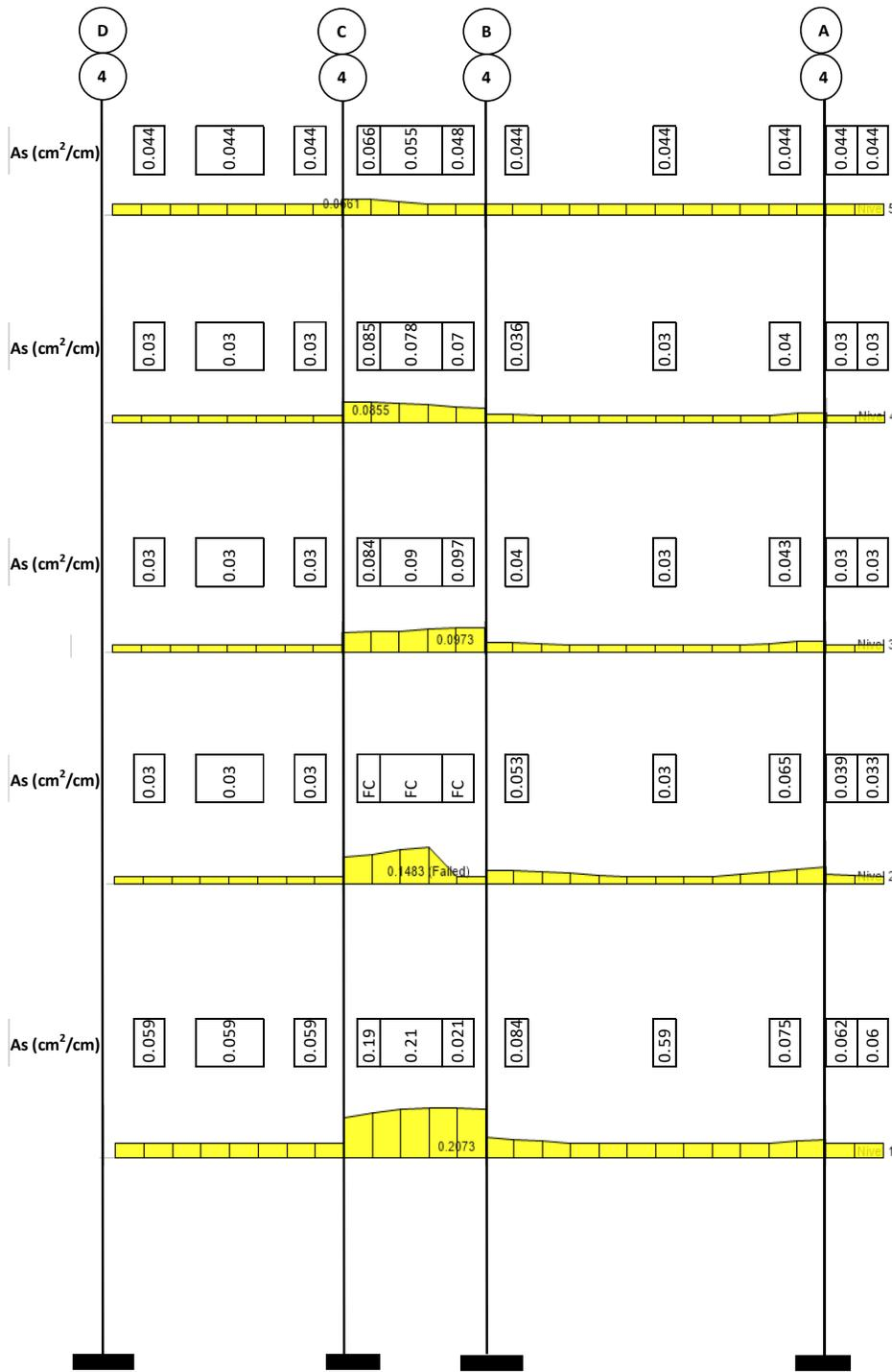
Figura 7-57 Demandas de acero transversal (NTC-DCEC, 2017) del marco 4
