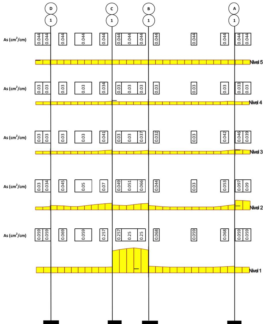
Figura 7-54 Demandas de acero transversal (NTC-DCEC, 2017) del marco 1
