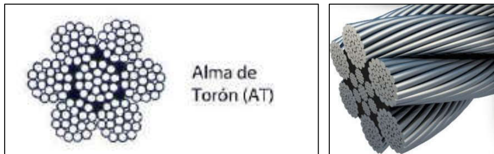
Figura 2.13 Sección transversal de un cable de presfuerzo
