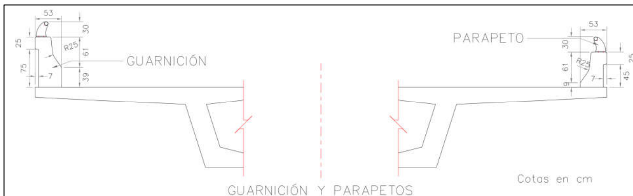
Figura 5.8 Sección transversal de las guarniciones y parapetos
