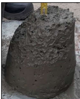
Figura 2.2 Consistencias del concreto
