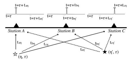
**Figura 4.** Diagrama del método de detección desarrollado por Kao & Shan en 2004. Cada estación tiene una máxima amplitud obtenida a partir del sismograma, se obtiene un tiempo de esta amplitud y un tiempo teórico por un modelo de velocidades a). Con ese tiempo viaja desde un punto en el espacio, la "luminosidad" se calculará sumando las amplitudes normalizadas y será mayor en el punto que coincida en todas las estaciones de la red. (Imagen modificada de Kao y Shan).
