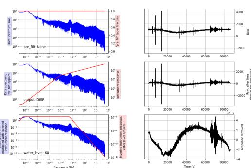
Figura 18. Respuesta instrumental de los sensores de la red GA. La gráfica se obtuvo con la opción de Obspy (paquetería en Python para el procesamiento de datos sísmicos). Se muestra la forma de la respuesta instrumental en rojo. El sismograma ingresado corresponde a la estación "BLUE" del día 5 de septiembre del 2021 y la componente "HHE".
