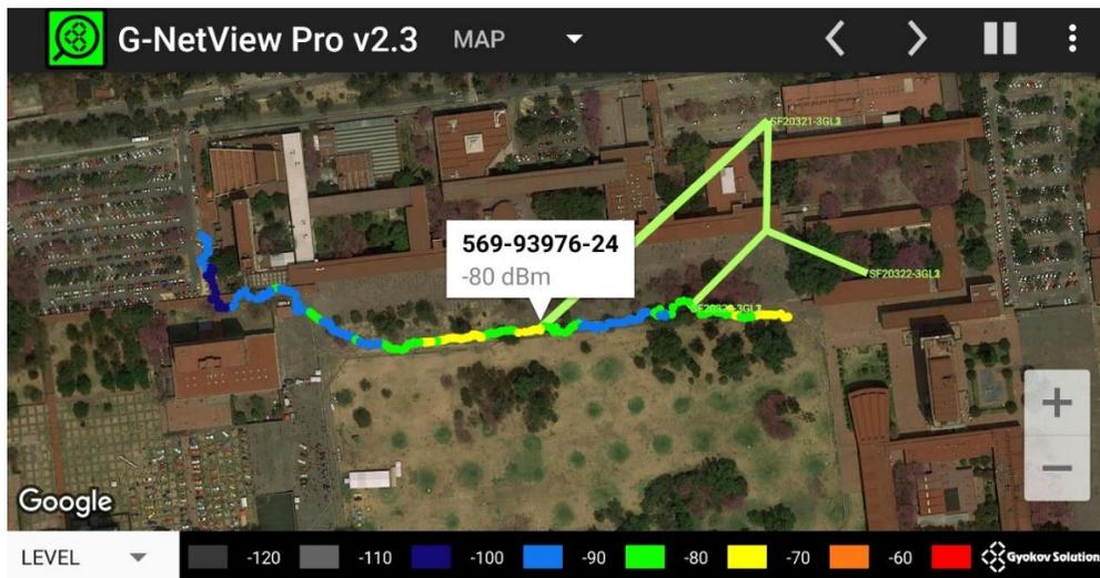
Figura 4.1013 Animación que permite observar, para cada punto del recorrido experimental, la radio base con el que el dispositivo móvil estableció conexión.
