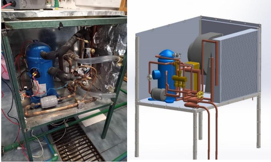
*Figura 4-2. Primer diseño de la bomba de calor geotérmica en grupo iiDEA.*
