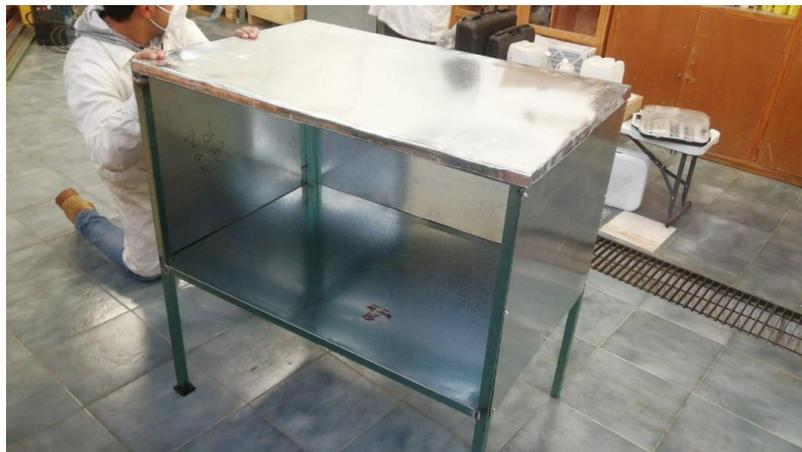
*Figura 5-8. Tapas de acero galvanizado colocadas en la estructura de PTR (Diseño y construcción de una bomba de calor geotérmica 3 TR, 2022)*
