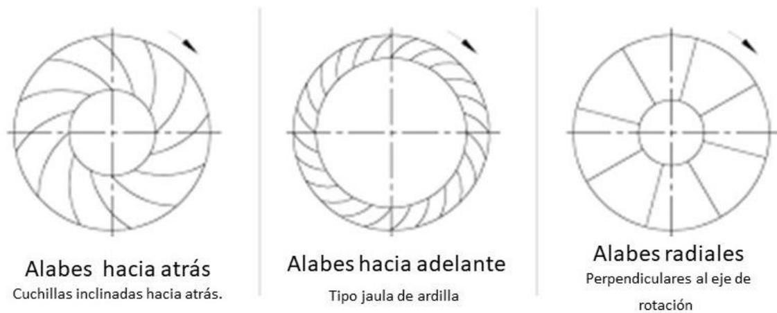
Figura 3-9. Tipos de ventiladores centrífugos
