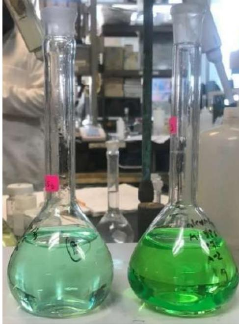
**Figura 15.** Digestión ácida antes de aforarlo en matraz volumétrico.
