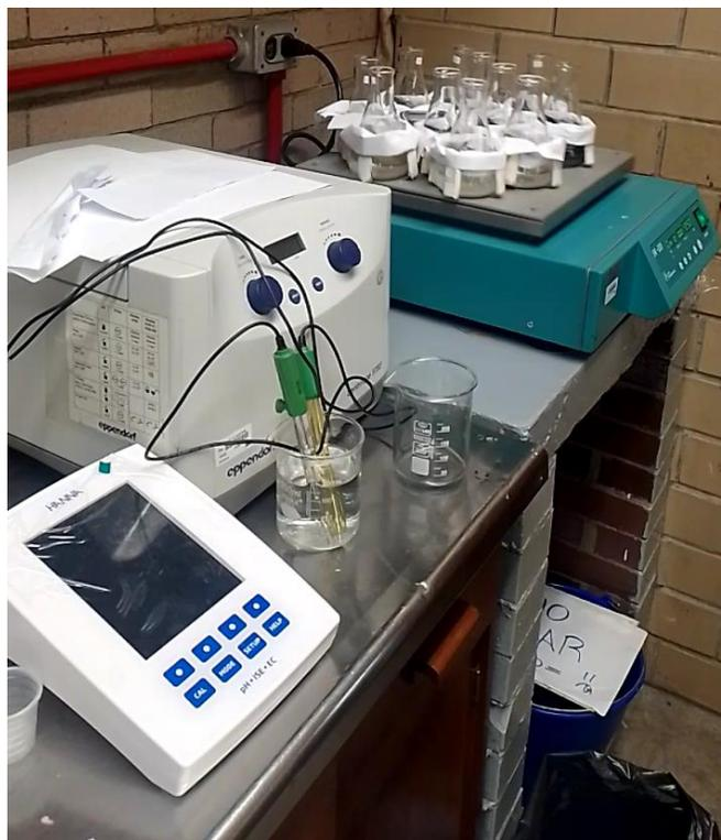
**Figura 20.** Sistema de lixiviación usado en las pruebas preliminares
