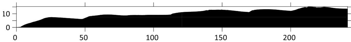
Ilustración 82 Perfil topográfico del transecto 6, obtenido mediante el DEM del vuelo a 40m de distancia. Área = 2466.11m<sup>2</sup>.
