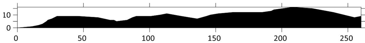
Ilustración 89 Perfil topográfico del transecto 8, medido con GPS en modo RTK. Área = 2488m<sup>2</sup>.
