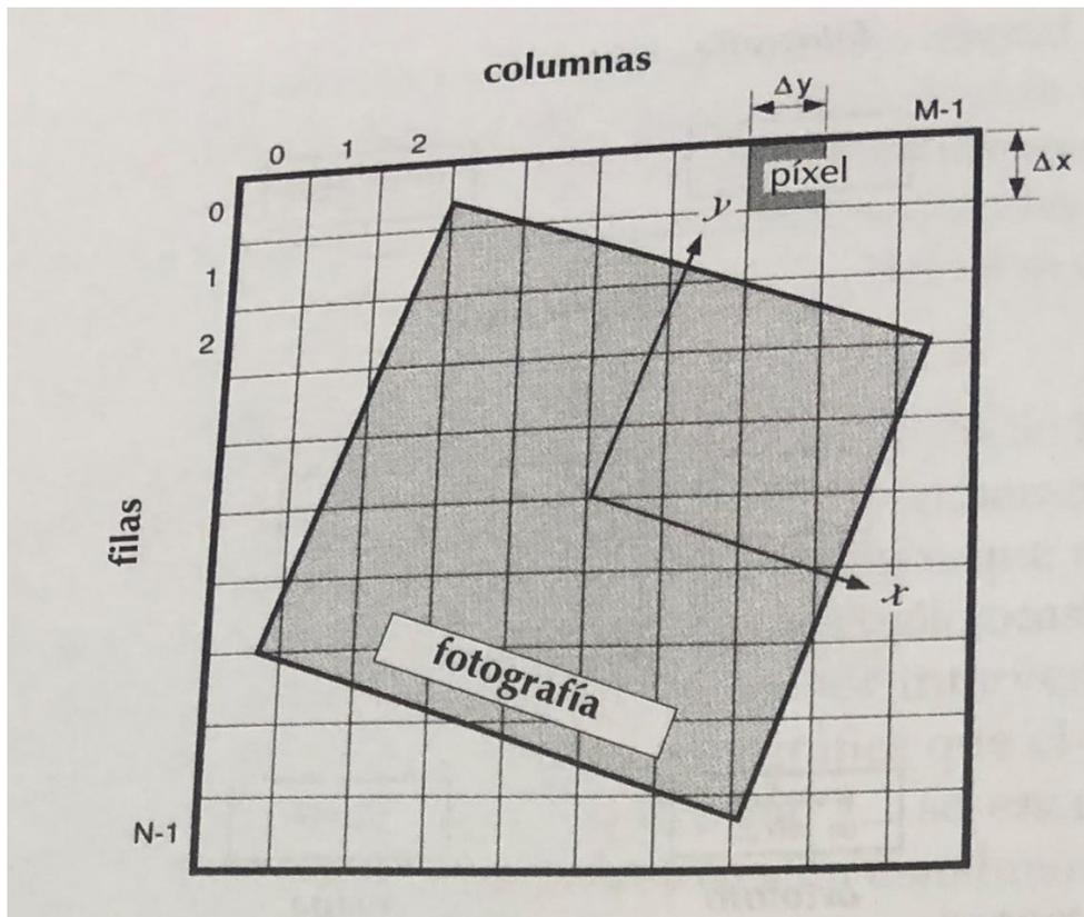
Ilustración 5 Sistema de coordenadas imagen para una imagen digital. El cuadrado girado y sombreado representa una fotografía digitalizada con los ejes fotocoordenados. *Fotogrametría digital*, Toni Schenk
