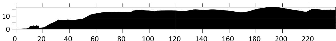
*Ilustración 103 Perfil topográfico del transecto 11, obtenido mediante el DEM del vuelo a 50m de distancia. Área = 2910.81m<sup>2</sup>.*
