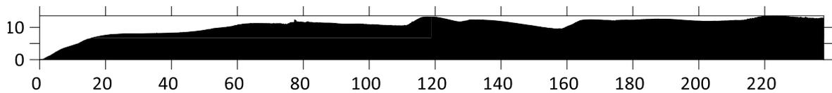
Ilustración 75 Perfil topográfico del transecto 4, obtenido mediante el DEM del vuelo a 50m de distancia. Área = 2527.83m<sup>2</sup>.
