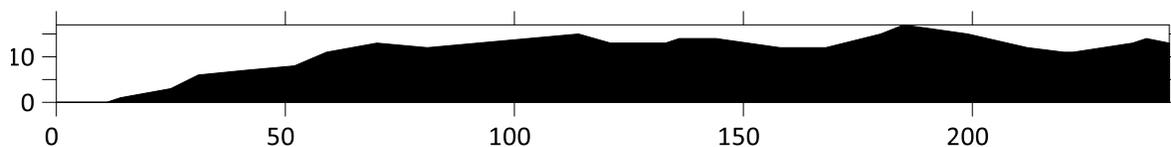
*Ilustración 101 Perfil topográfico del transecto 11, medido con GPS en modo RTK. Área = 2707.5m<sup>2</sup>.*
