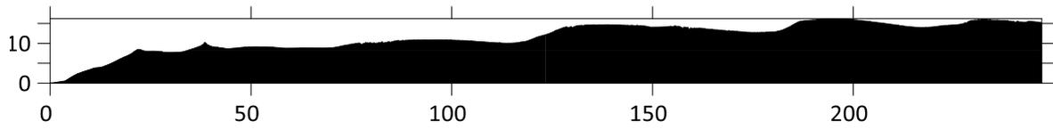
Ilustración 87 Perfil topográfico del transecto 7, obtenido mediante el DEM del vuelo a 50m de distancia. Área = 2851.90m<sup>2</sup>.
