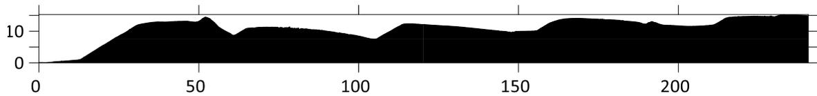
*Ilustración 67 Perfil topográfico del transecto 2, obtenido mediante el DEM del vuelo a 50m de distancia. Área = 2630.97m<sup>2</sup>.*
