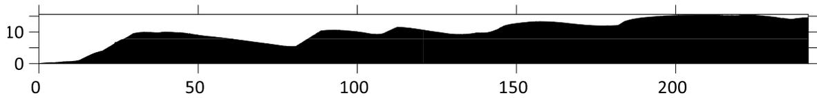
Ilustración 94 Perfil topográfico del transecto 9, obtenido mediante el DEM del vuelo a 40m de distancia. Área = 2489.02m<sup>2</sup>.
