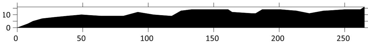
Ilustración 85 Perfil topográfico del transecto 7, medido con GPS en modo RTK. Área = 2925m<sup>2</sup>.
