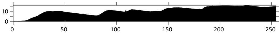
Ilustración 92 Perfil topográfico del transecto 8, obtenido mediante el DEM del vuelo a 60m de distancia. Área = 2745.59m<sup>2</sup>.
