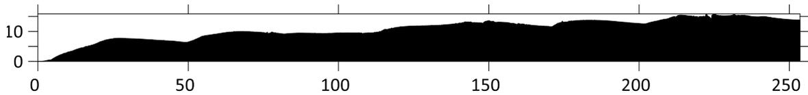
Ilustración 84 Perfil topográfico del transecto 6, obtenido mediante el DEM del vuelo a 60m de distancia. Área = 2729.12m<sup>2</sup>.
