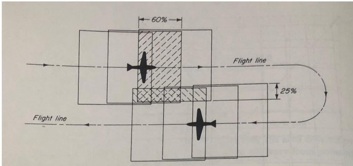
Ilustración 6 Superposición transversal. Fotogrametría digital, Toni Schenk, 2002.
