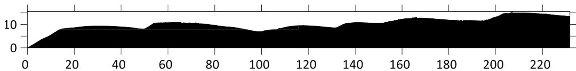
*Ilustración 70 Perfil topográfico del transecto 3, obtenido mediante el DEM del vuelo a 40m de distancia. Área = 2378.87m<sup>2</sup>.*
