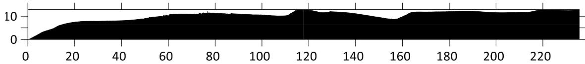
Ilustración 74 Perfil topográfico del transecto 4, obtenido mediante el DEM del vuelo a 40m de distancia. Área = 2425.82m<sup>2</sup>.
