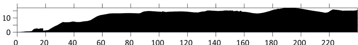
*Ilustración 104 Perfil topográfico del transecto 11, obtenido mediante el DEM del vuelo a 60m de distancia. Área = 2915.58m<sup>2</sup>.*
