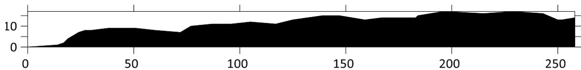
Ilustración 93 Perfil topográfico del transecto 9, medido con GPS en modo RTK. Área = 3034m<sup>2</sup>.
