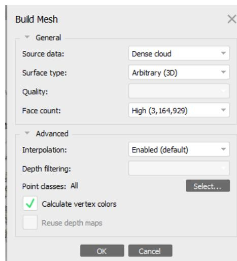
*Ilustración 30 Parámetros para la construcción de la malla.*
