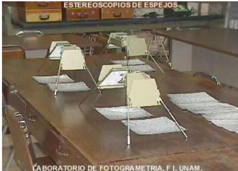
*Ilustración 1 Estereoscopio de Espejos. Fuente: Facultad de Ingeniería de la UNAM. ([http://dicyg.fi-c.unam.mx/html/infraestructura/laboratorios/fotogrametria/galeria\\_fotogrametria.html](http://dicyg.fi-c.unam.mx/html/infraestructura/laboratorios/fotogrametria/galeria_fotogrametria.html))*
