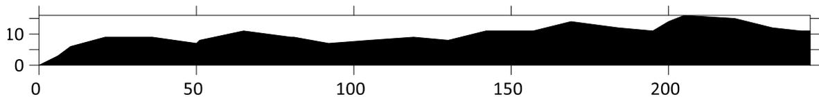
*Ilustración 69 Perfil topográfico del transecto 3, medido con GPS en modo RTK. Área = 2488.50m<sup>2</sup>.*
