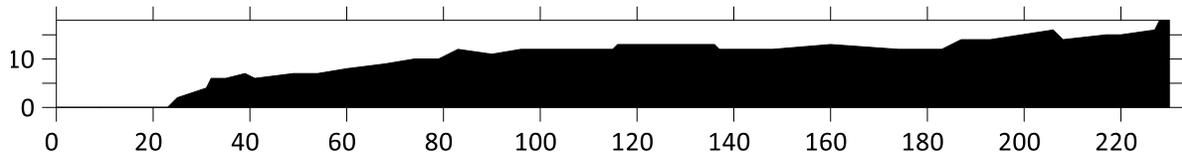
Ilustración 97 Perfil topográfico del transecto 10, medido con GPS en modo RTK. Área = 2358.50m<sup>2</sup>.
