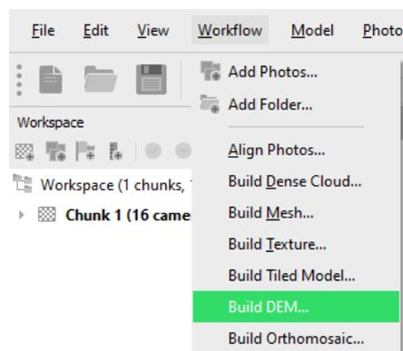
Ilustración 33 Crear Modelo Digital de Superficie o elevaciones.
