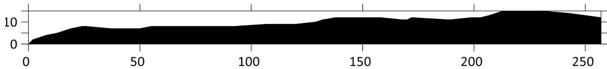
Ilustración 81 Perfil topográfico del transecto 6, medido con GPS en modo RTK. Área = 2586m<sup>2</sup>.
