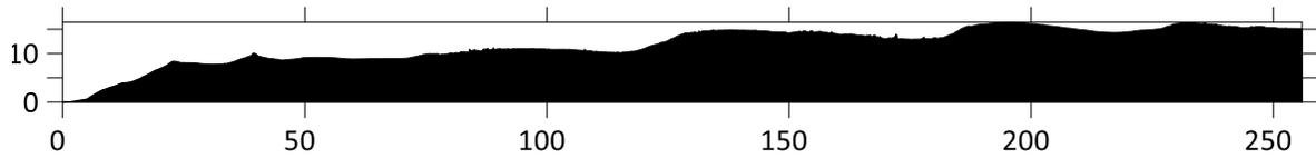
Ilustración 88 Perfil topográfico del transecto 7, obtenido mediante el DEM del vuelo a 60m de distancia. Área = 3013.02m<sup>2</sup>.
