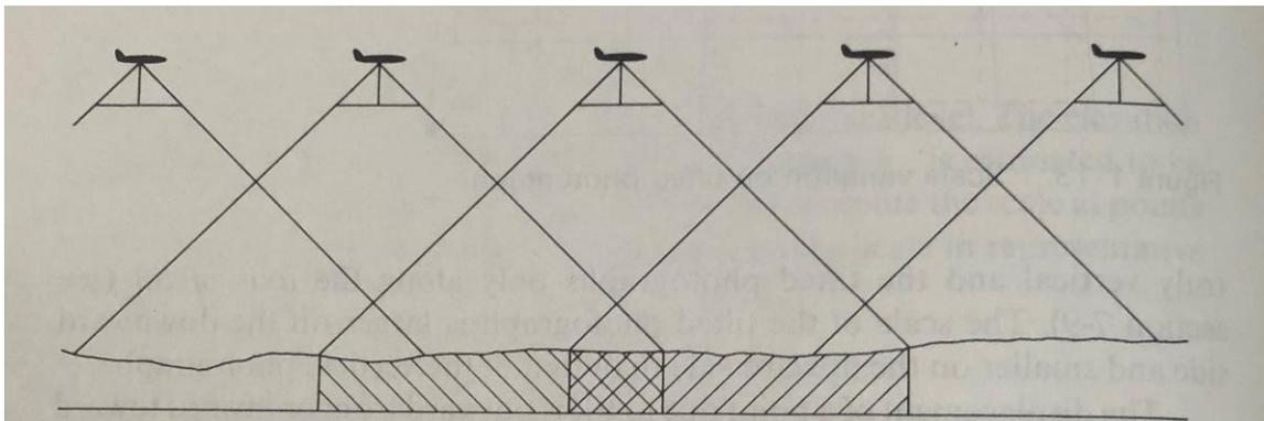
Ilustración 7 Superposición longitudinal. Fotogrametría digital, Toni Schenk, 2002.
