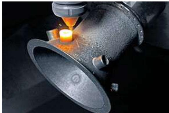
*Figura 1.7 Pieza fabricada por DED (cortesía de ALL3DP).*
