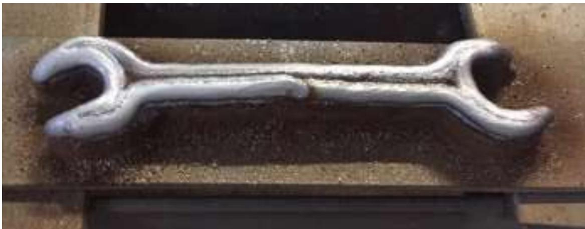
*Figura 4.5 Manufactura aditiva de llave de Prueba 3.*
