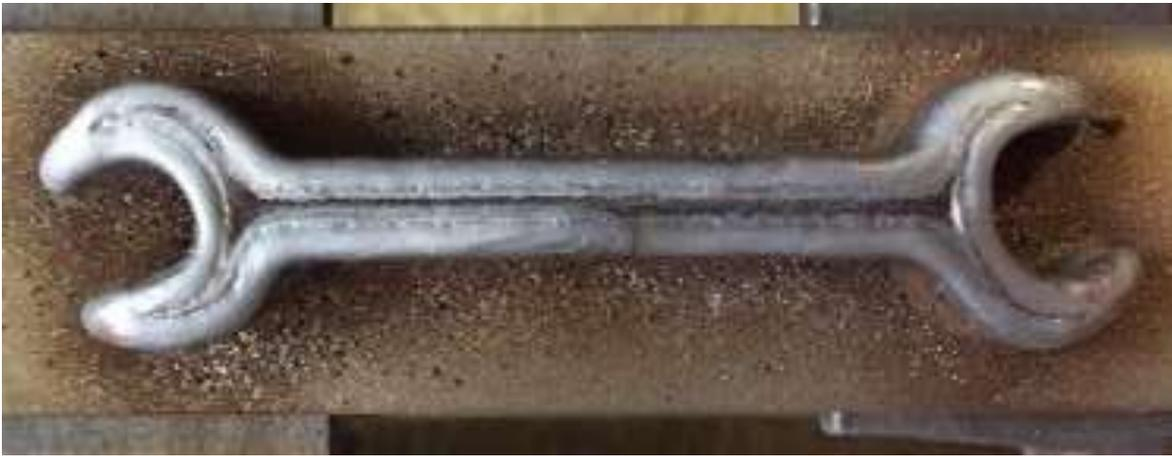
*Figura 4.4 Manufactura aditiva de llave de Prueba 3.*
