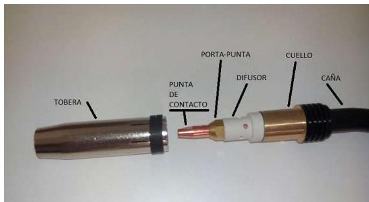
**Figura 1.24 Tobera y boquillas del proceso MIG.**
