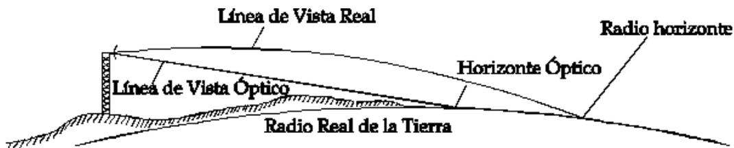
Fig. 2.8 Curvatura del Haz y radio horizonte.
