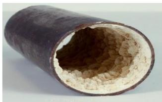
**Fig. (37).** Incrustaciones en tuberías. (purewater, 2023)
