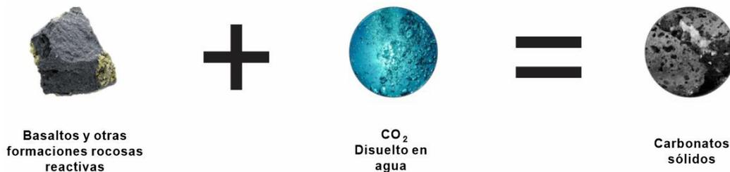
**Figura 13.** Representación gráfica de la reacción del CO<sub>2</sub> en basaltos. Obtenido de *How it Works*, Carbfix, 2023, recuperado de: <https://www.carbfix.com/how-it-works>
