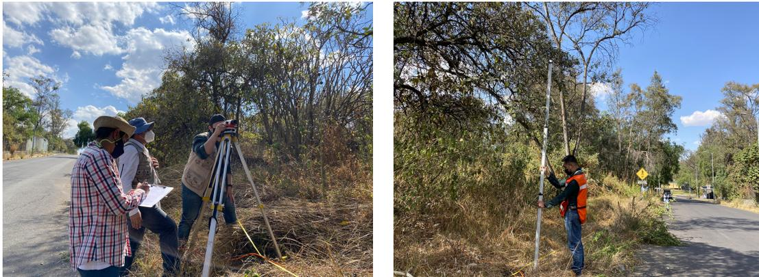
Figura 5.11: Memoria fotográfica de la toma de nivelación realizada en la línea 1 de REPSA A8, posteriormente se realizó la toma en las líneas de tendido 2 y 3, así como, sus correspondientes separaciones electrónicas reales.
