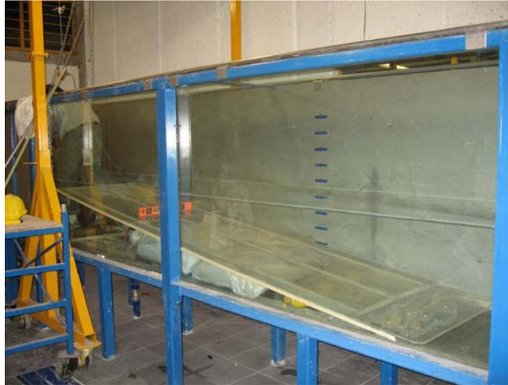
**Figura III.3** Posición final de la rampa para el caso impermeable de talud 1:8
