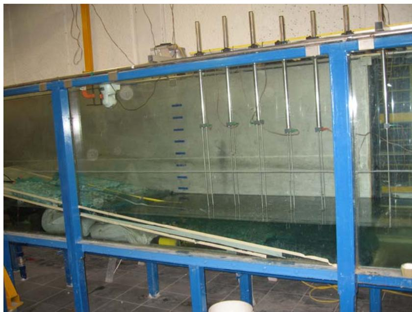
**Figura III.4** Rampa con medio poroso de dos pulgadas
