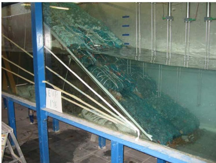
Figura III.5 Forma y posición de los sacos de grava para las pendientes más inclinadas
