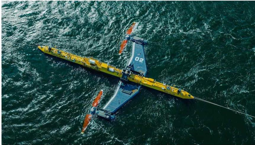
Figura 2-3. Turbina O2. Tomado de [10].
