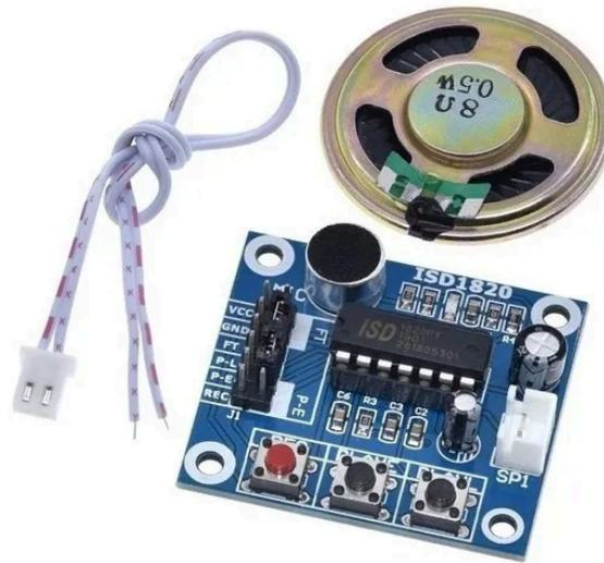
Figura 19. Módulo ISD1820 para reproducción de audio.
