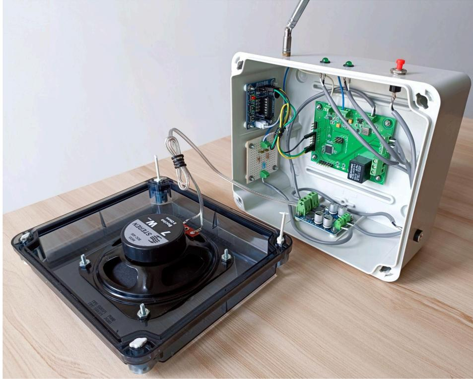
Figura 26. Interior del prototipo de receptor de alertas para una casa u oficina pequeña.
