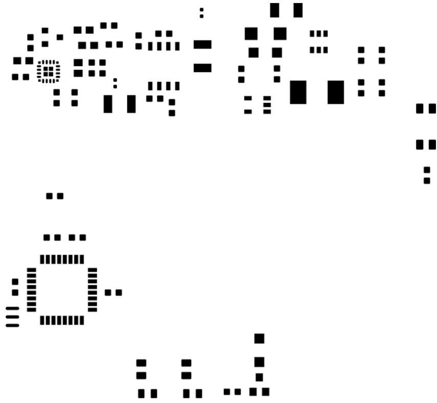
Figura B.2.7. Diseño de la pasta para soldar superior.
