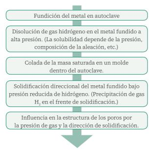
Figura 10. Espumado de metales por el método GASAR [28]
