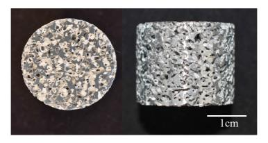
Figura 5. Espumas metálicas base aluminio
