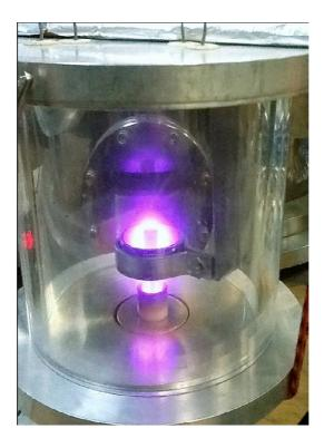
**Figura 10.** Observación del plasma generado en un equipo de nitruración iónica de una fundición nodular [21].
