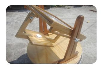
**Figura 5.** Prototipo de un concentrador que emplea una lente de Fresnel para investigación en manufactura (i.e. soldaduras, sinterización); de la Facultad de Ineniería, UNAM [5]
