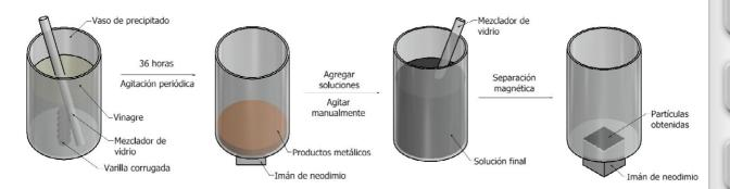
Figura 1. Esquema del proceso de síntesis de partículas 2.1
