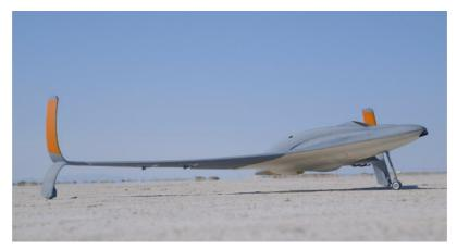
Figura 6 UAV, dron impreso en 3D por Stratasys [22]
