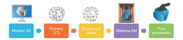
Figura 2. Proceso de fabricación AM
