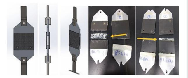
Figura 23. Configuración del ensayo y probetas de unión con falla [50]
