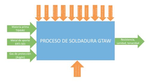
Figura 7. Fuentes de variación del proceso GTAW [18]
