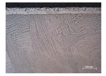
Figura 4. Nitruración exitosa de titanio lograda por tratamiento con ESC [1]
