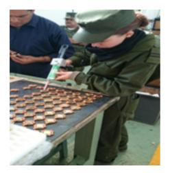
Figura 12. Unión adhesiva en medallas de acero a pin plástico Cortesía de ASI®.
