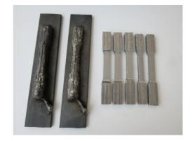
**Figura 18.** a) Trayectorias de impresión; b) Probetas impresas en metal ER70S-6 y el maquinado correspondiente
