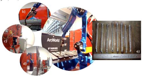
Figura 3. Fotografias que muestran: a) celda robotizada para proceso de soldadura CMT®, b) acercamiento de la antorcha, posicionador y mampara, c) equipo de soldadura CMT® y fuente de potencia, d) vista de mamparas protectoras, y e) ejemplo de cordones depositados.
