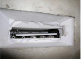
**Figura 8.** Cámaras termosolares para procesado de materiales cerámicos para muestras "pequeñas" y "medianas" [7].
