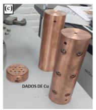
Figura 7. Accesorios para suction casting. (a) Horno de arco eléctrico abierto, (b) Plato de Cu y bobina de enfriamineto (c) Dados de Cu
