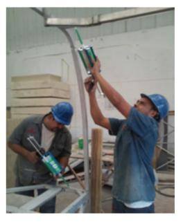
Figura 15. Unión adhesiva en carrocería metálica Cortesía de ASI®.
