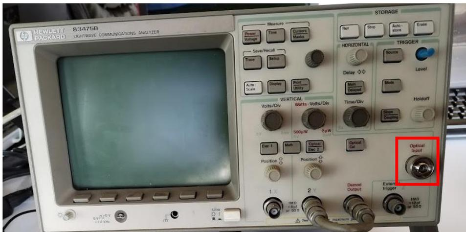
Figura 23. Entrada óptica del analizador.
