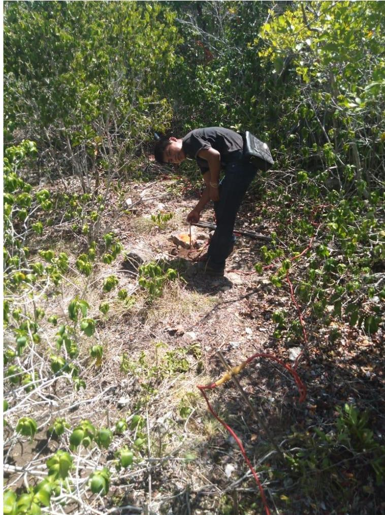
*Figura 28 Colocación de electrodos largos para aumentar la superficie de contacto y mejor la calidad de la señal.*
