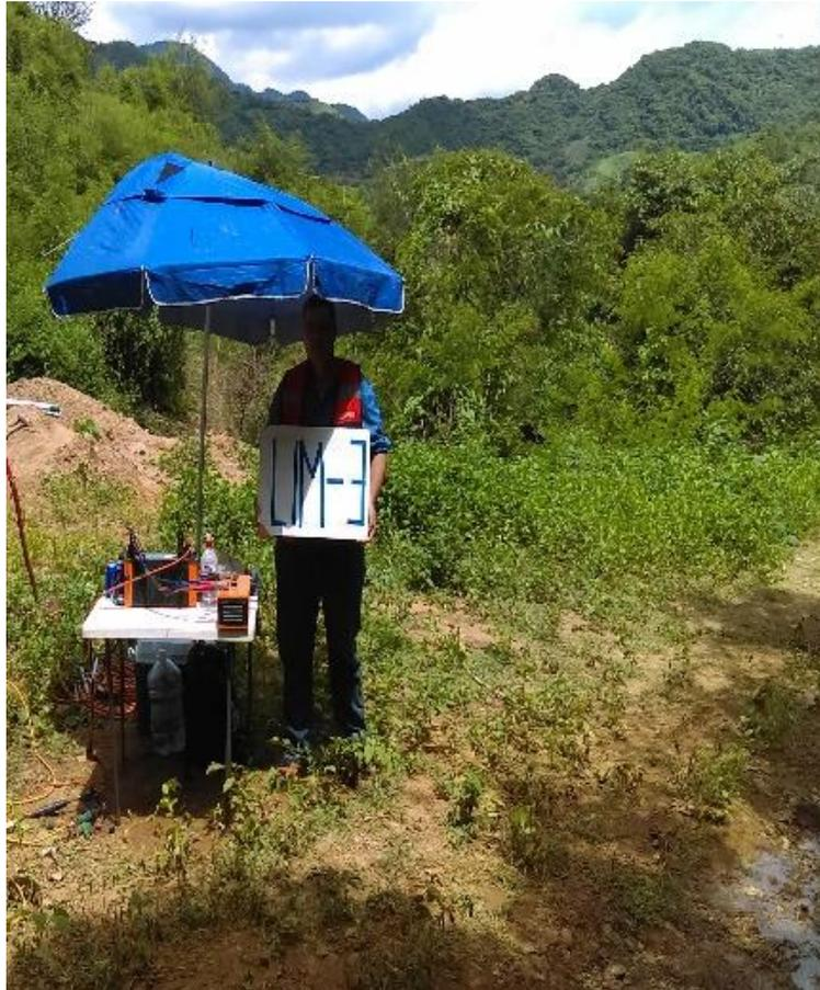
*Figura 40 Equipo ARES durante la adquisición de la línea de tomografía.*
