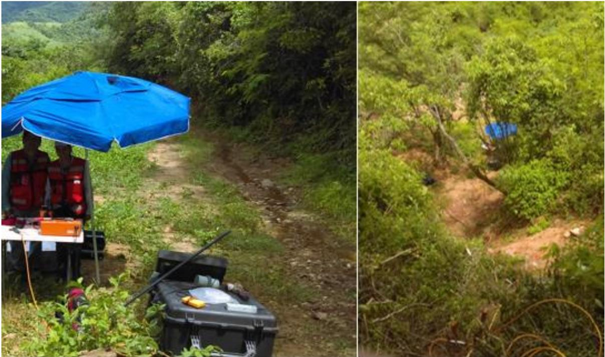
*Figura 39 Se observa el equipo Ares 1 y la colocación de los electrodos en campo.*
