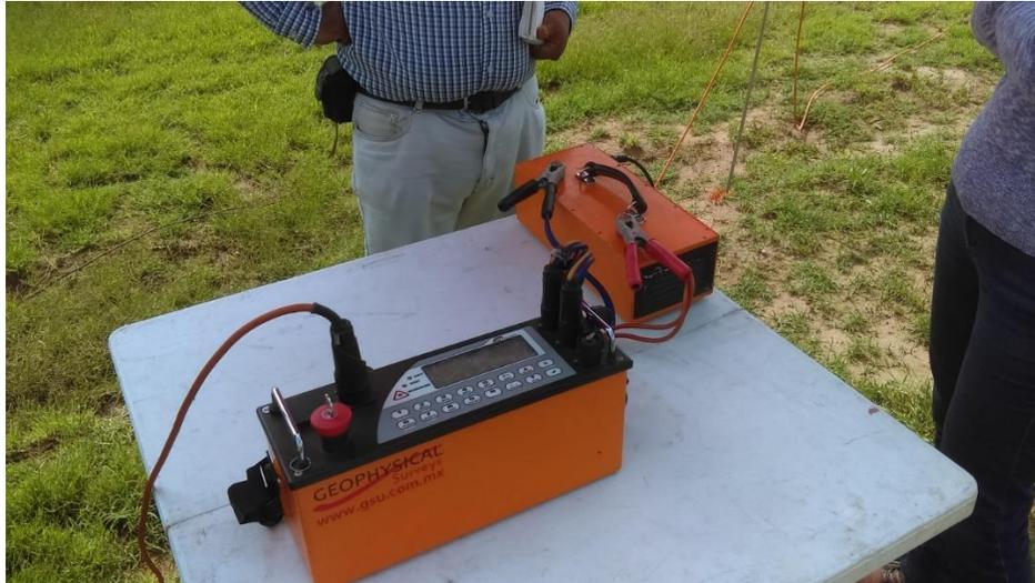
Figura. 18 Equipo ARES I utilizado para el proyecto.
