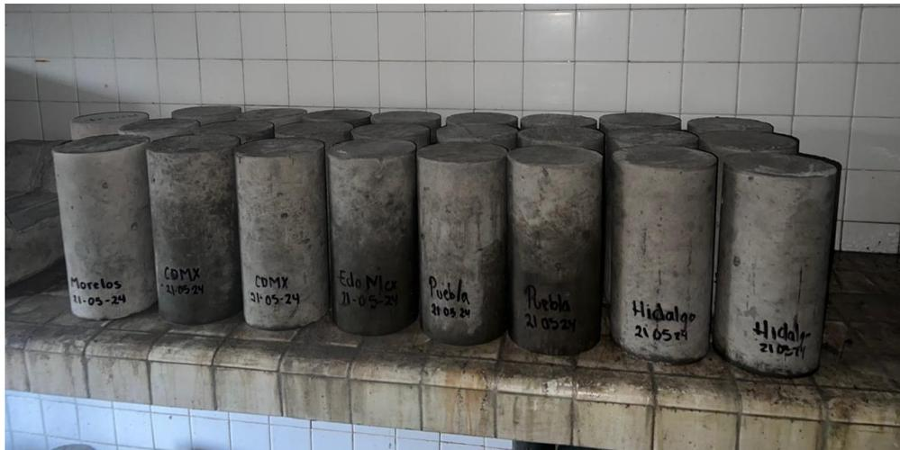
*Ilustración 18 Cilindros en el cuarto de Curado*
