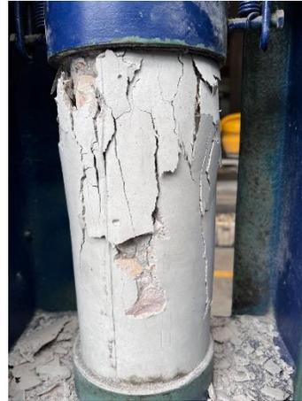
Ilustración 24 Falla de Cilindro
