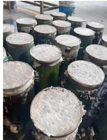
*Ilustración 17 Cilindros en Moldes*
