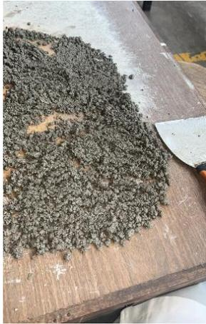
*Ilustración 3 SSS Agregado Fino*
