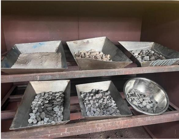
Ilustración 11 Agregados en horno
