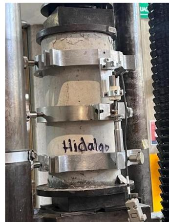
*Ilustración 20 Extensómetros*
