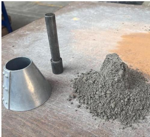
*Ilustración 4 SSS Agregado Fino Cono*
