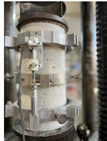
Ilustración 22 Cilindro en la Máquina Universal
