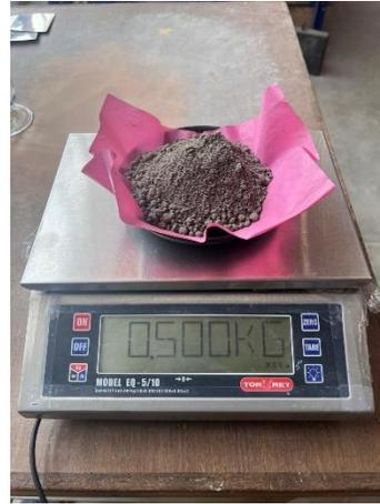
*Ilustración 5 Volumen Conocido Agregado Fino*
