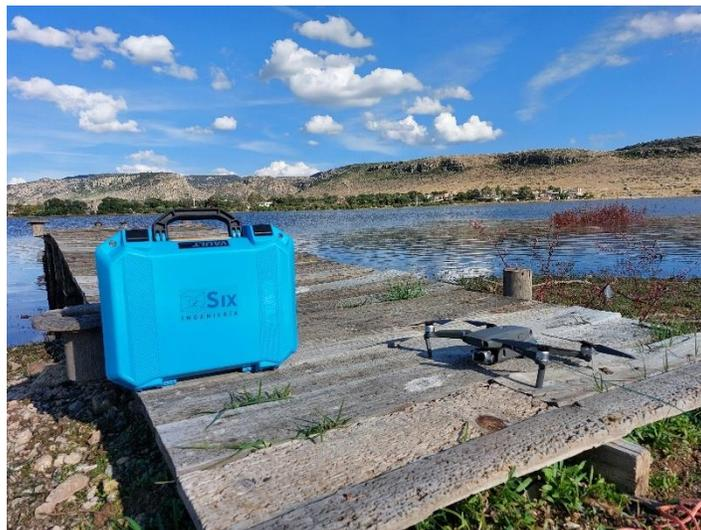
*Figura 2. Dron utilizado para la obtención de fotogrametría. Elaboración propia.*
