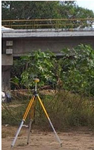
*Figura 4. Colocación de BASE en BN1. Elaboración propia.*
