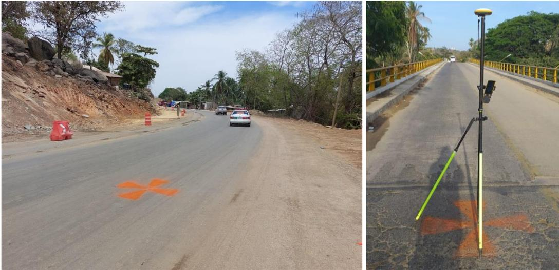
*Figura 1. Colocación de puntos de control. Elaboración propia.*
