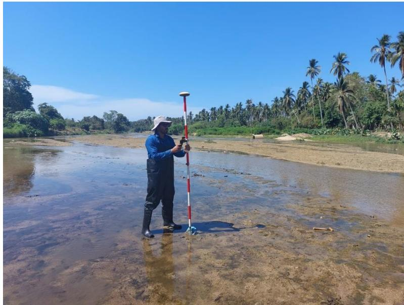
*Figura 6. Levantamiento de poligonal de apoyo con puntos RTK. Elaboración propia.*
