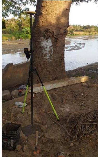
*Figura 5. Colocación de ROVER en BN2. Elaboración propia.*
