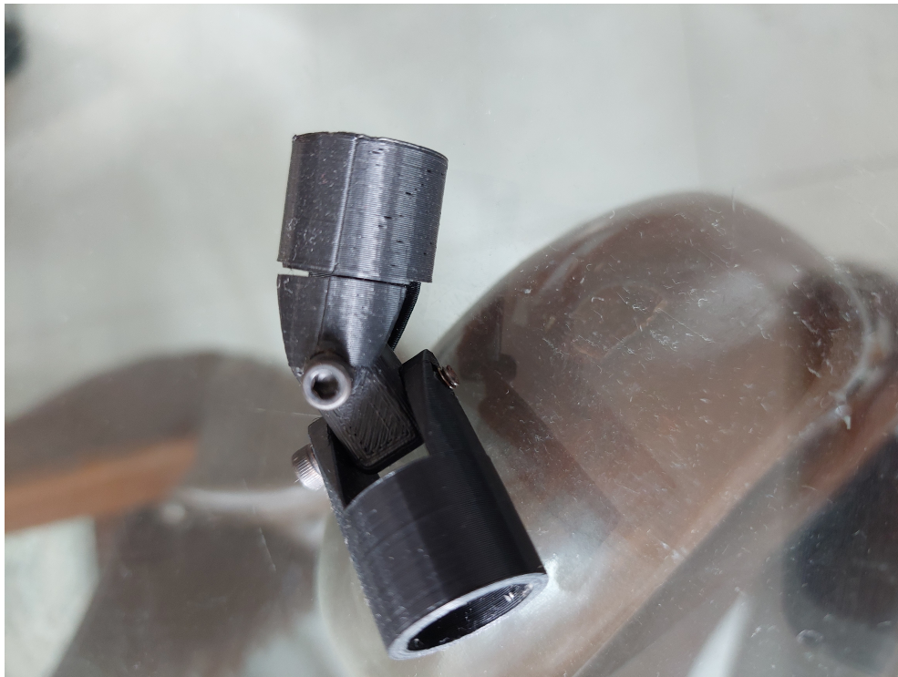
Figura 4.26: Ruptura del porta-cámaras
