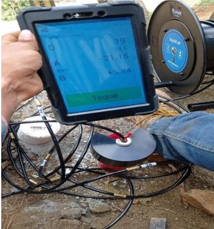
**Figura 25.** Lectura del inclinómetro en el túnel San Sebastián.
