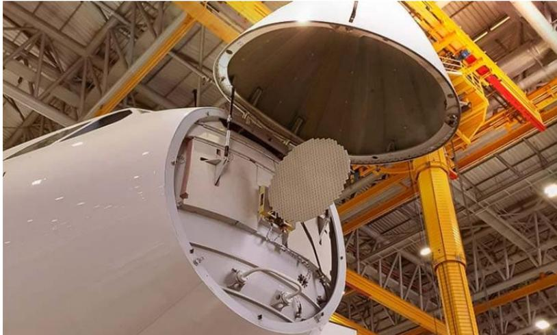
Figura 2.86: Radomo de un avión, imagen obtenida de [37].
