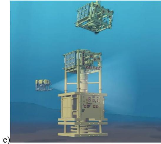
Nota: a) OWIRS. EDP/LRP instalados en SSXT. b) Esquema de válvulas de compuerta. Cierre de las barreras de control. c) RTV cerrado. d) y e) Desconexión del conjunto EDP-riser C/WO dejando el pozo en condiciones seguras. Fuente: Expro.
