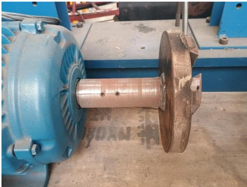
*Figura 15. Manivela donde se aprecia el mango que se fabricó en los talleres de la Facultad*
