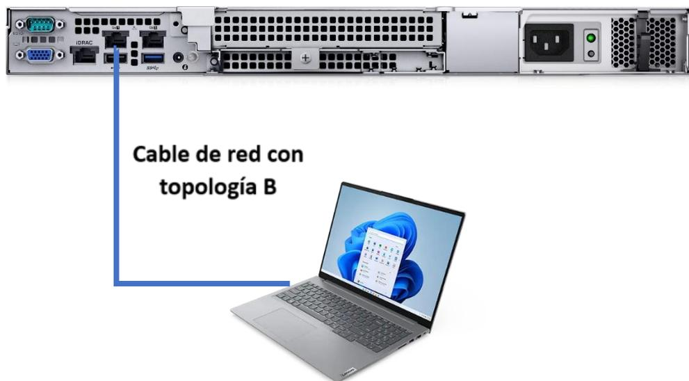
**Figura 3.29. Conexión directa para configuración del DMA**
