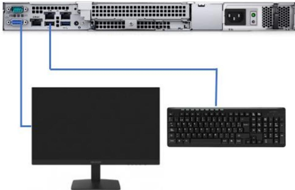
**Figura 3.28. Conexión para cargar sistema operativo y software del DMA.**
