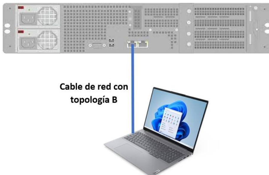
Figura 3.10. Conexión directa para configuración de equipo RMX 1800
