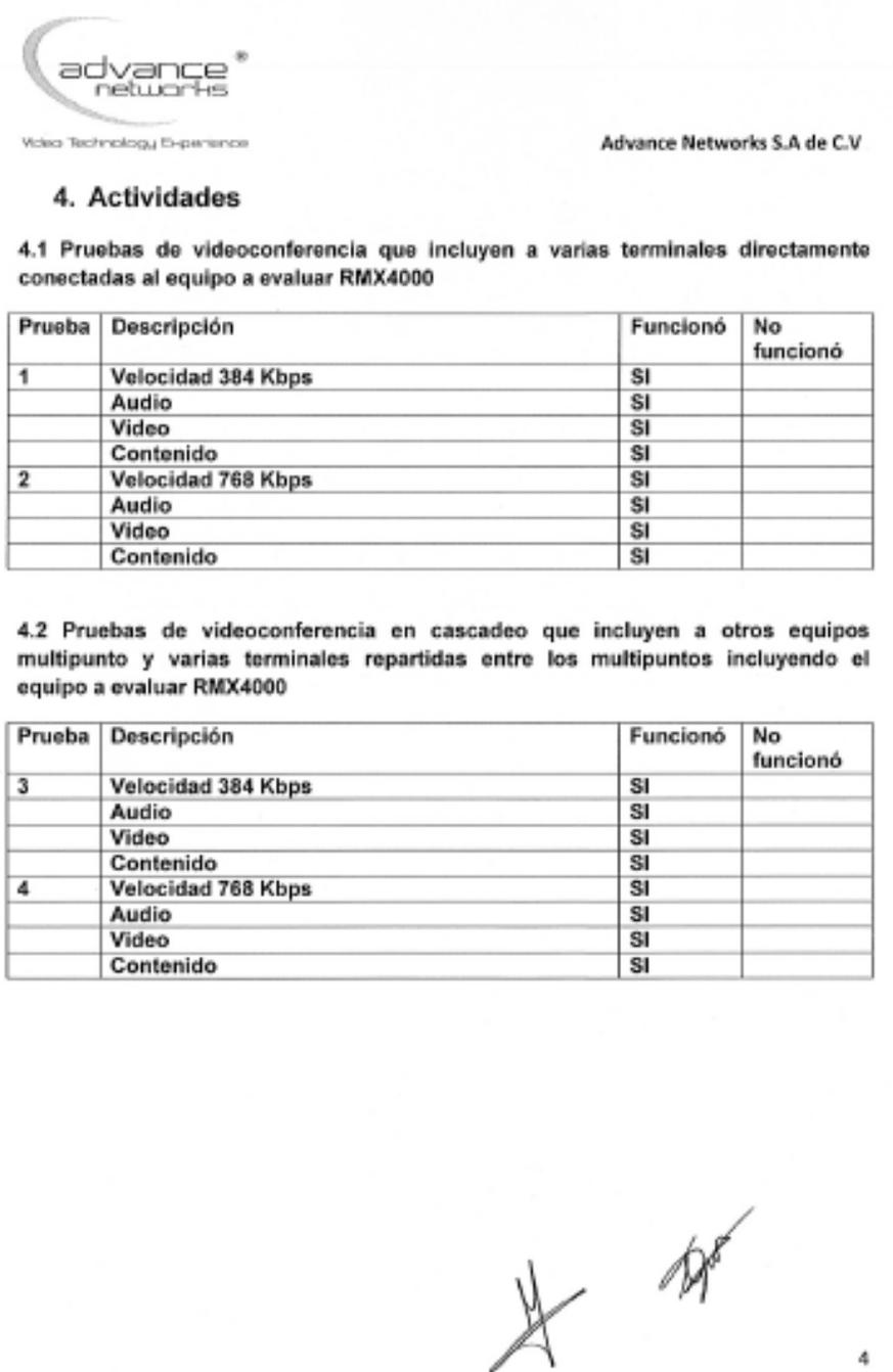
**Figura 2.10. Pruebas realizadas para buen funcionamiento del equipo.**
