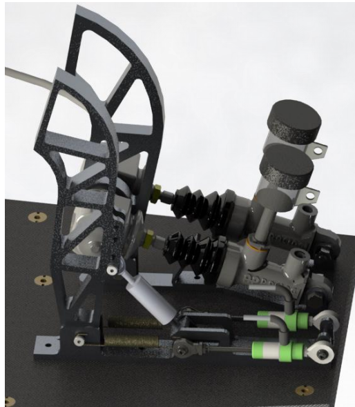
Figura 42. Pedal de acelerador del prototipo UM-E02
