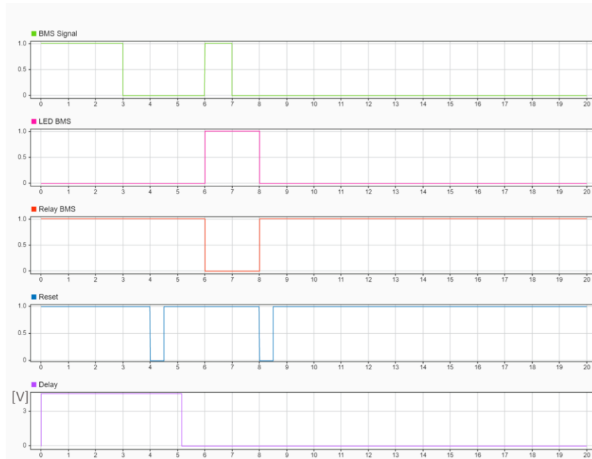
Figura 9. Señales de salida del circuito BMS
