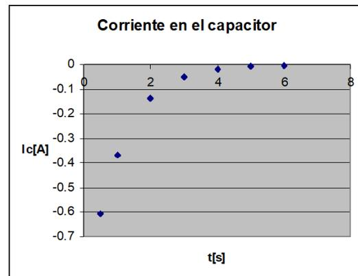
Al final de la descarga no hay ni voltaje ni corriente en el capacitor
