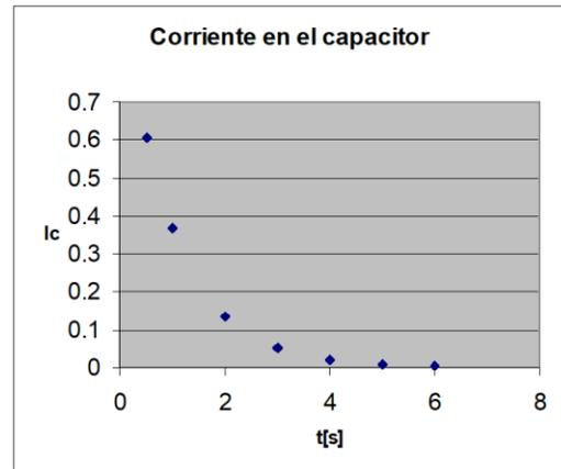
En el tiempo  $t=0$  el capacitor se comporta como un corto circuito ya que fluye la máxima corriente.
