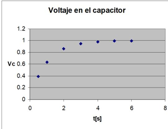
En las gráficas y en las ecuaciones, se observa que el capacitor, se carga y adquiere el voltaje de la fuente  $\epsilon$  para el tiempo  $t$  infinito. No existe diferencia de potencial en las terminales del resistor, por lo que la corriente es cero, es decir,
