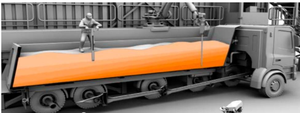
**Figura 6.** Muestreo sobre vehículo transportador.
