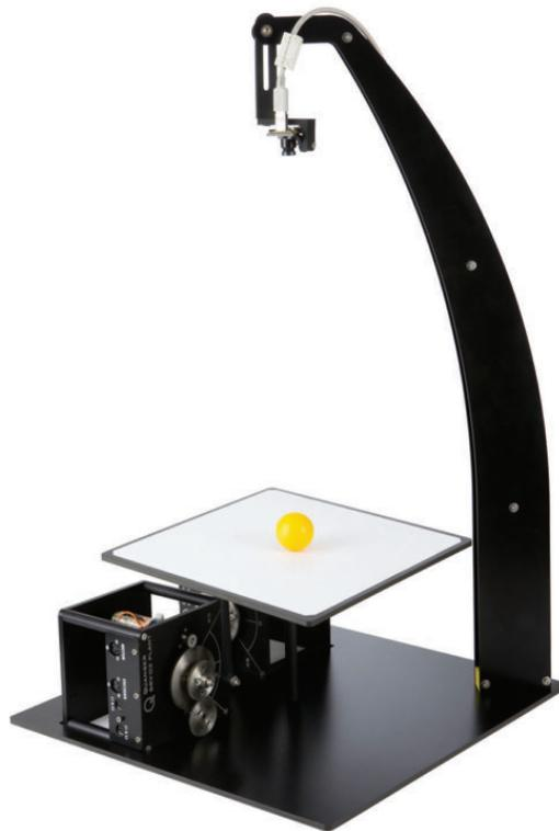
Figura 3.1: Imagen de la planta “2DOF Ball Balancer”
