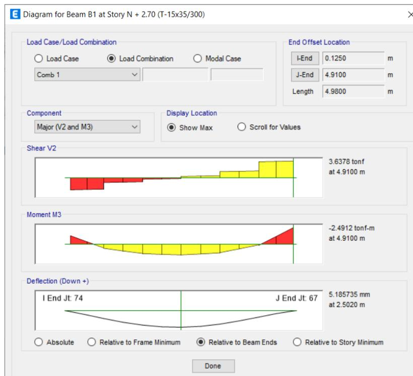
Figura 55. Elementos mecánicos sobre trabe de concreto. Combinación: 1.5 CM + 1.7 CV. Trabe B1
