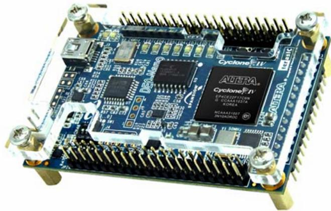
Figura 6.14: Dispositivo FPGA a utilizar [39].
