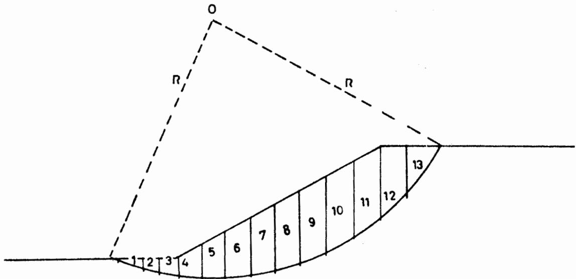
Fig II.43 Círculo de falla dividido en dovelas.
