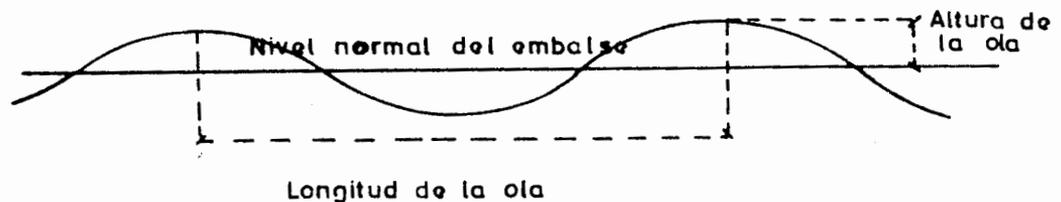
Fig II.26 Longitud y altura de la ola
