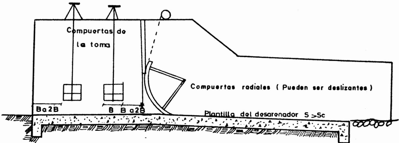
Fig VI.13 Perfil longitudinal de un canal desarenador.
