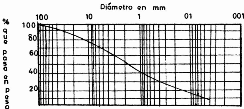
Fig II.8 Curva granulométrica de un suelo
