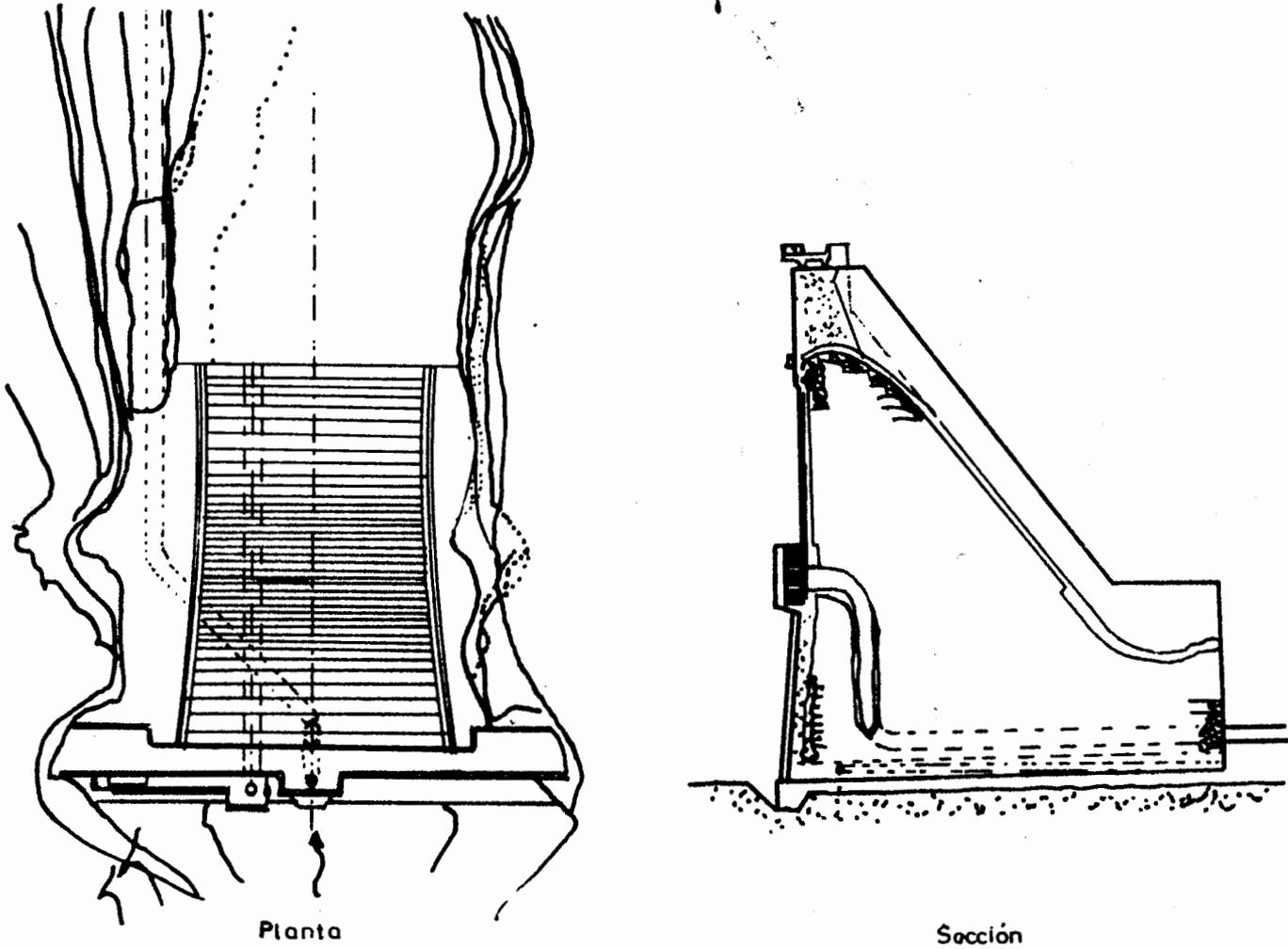
Fig. III.2 Presa de gravedad
