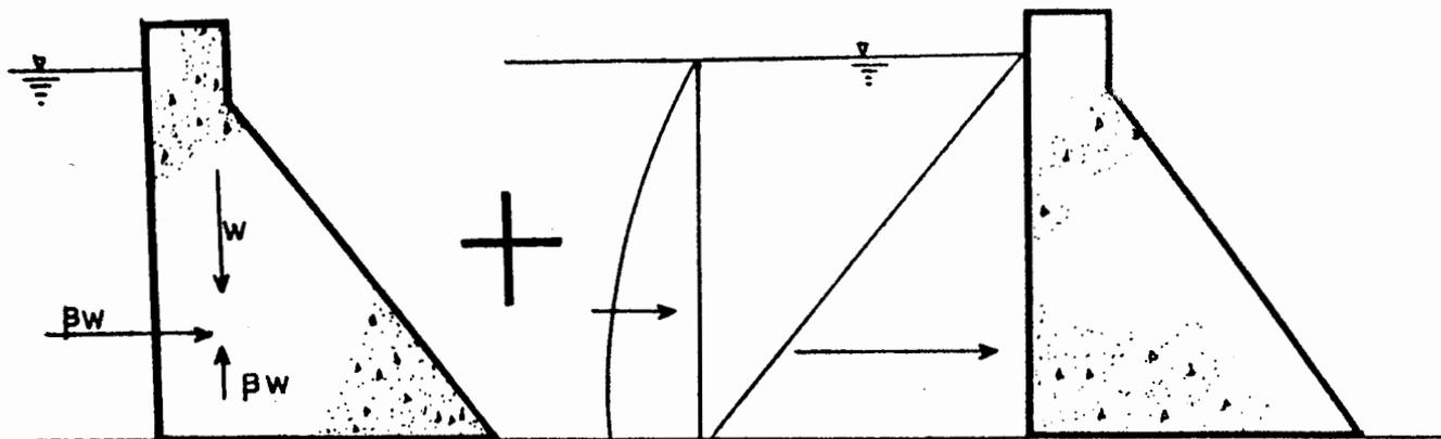
Fig III.18 Combinación de cargas producidas por sismo.
