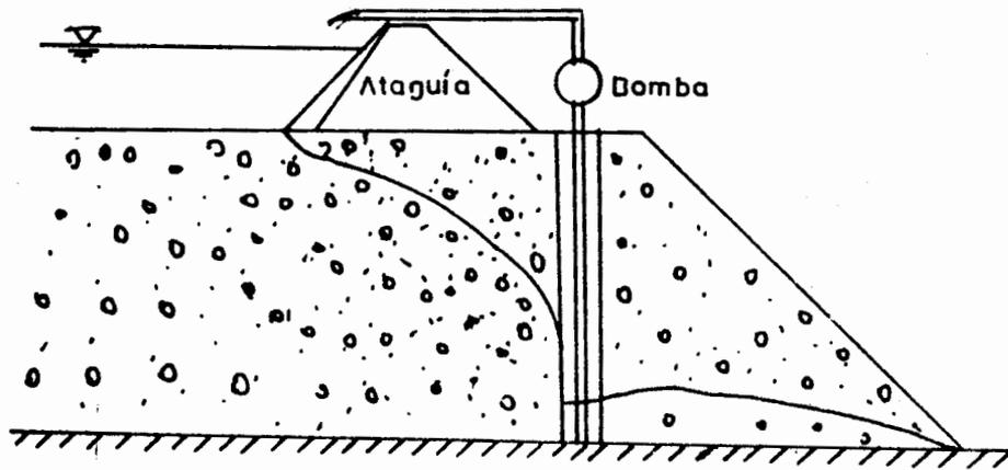
Fig II.56 Intercepción de filtraciones por medio de bombeo.
