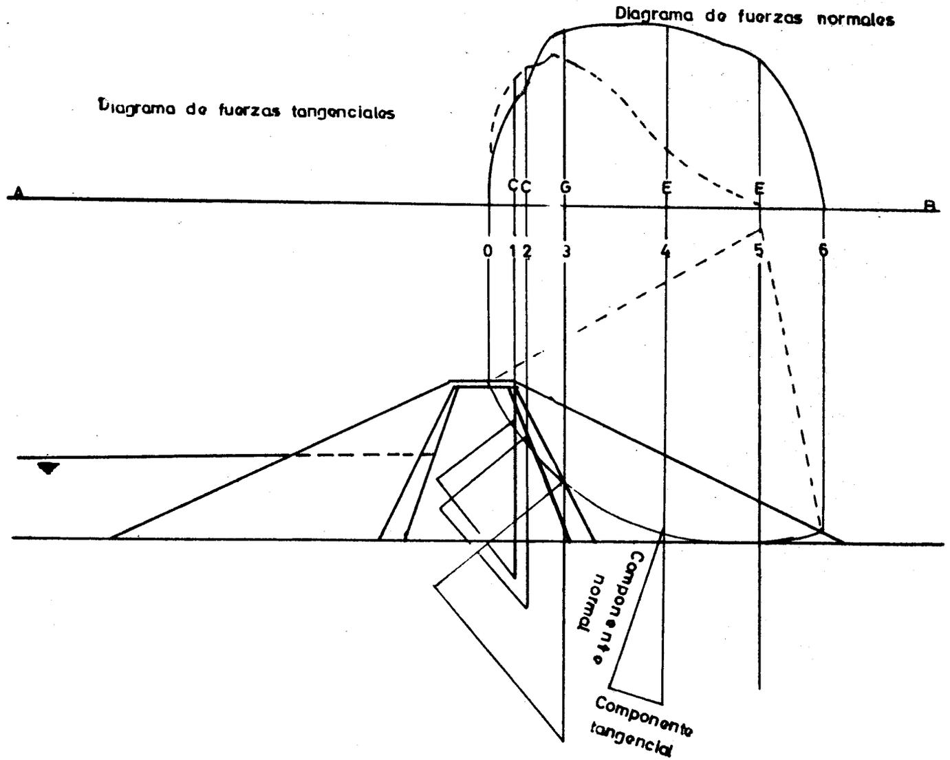
Fig II.48 Solución gráfica para análisis de estabilidad de taludes.
