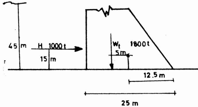
Fig. III.27 Sección de la presa del problema III.2
