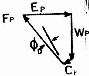
Fig II.53 Diagrama vectorial de la cuña pasiva.
