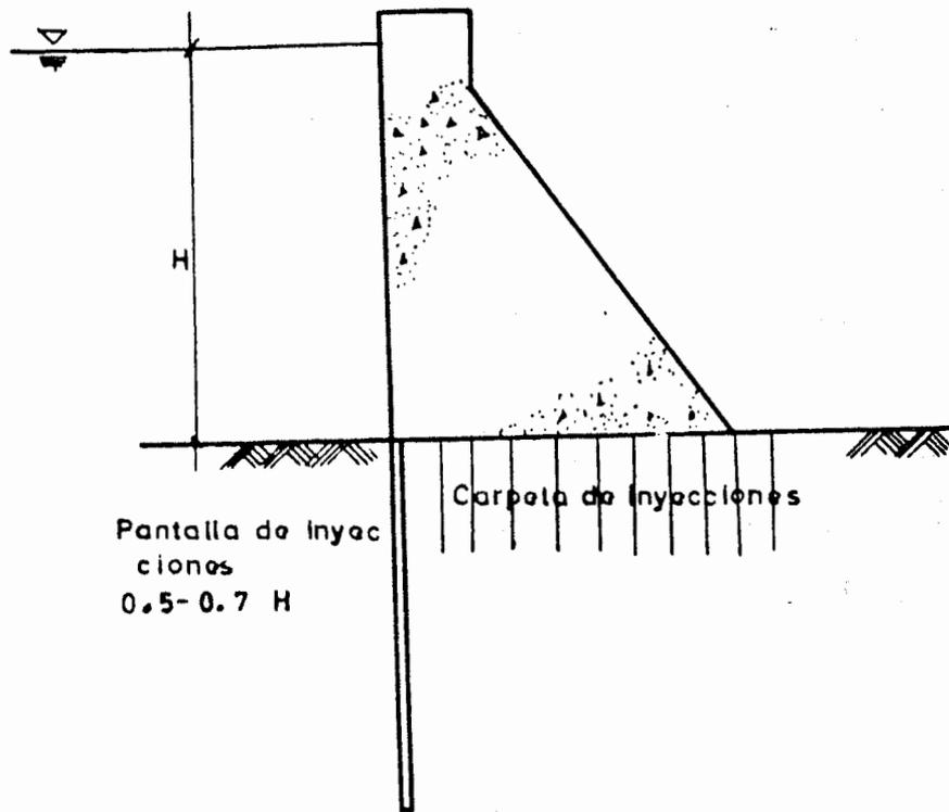
Fig III.10 Pantalla y carpeta de inyecciones
