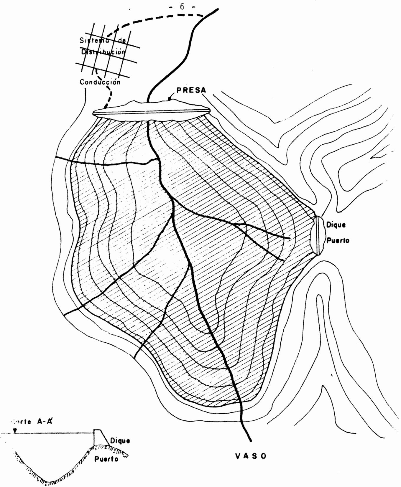
Fig I.I Elementos de un aprovechamiento hidráulico superficial y algunas estructuras de presas.
