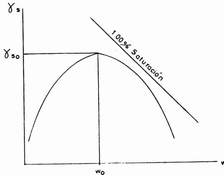
Fig II.40 Curva proctor típica y curva de saturación.
