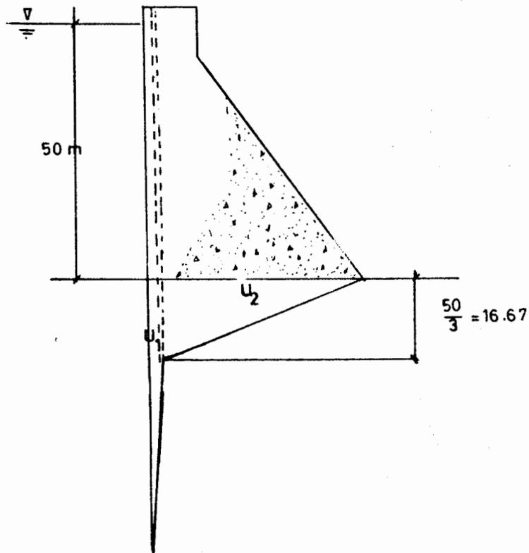
Fig. III.25 Diagramas de subpresión
