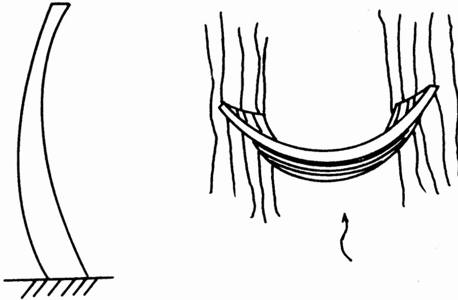
Fig V.4 Presa de arco bóveda
