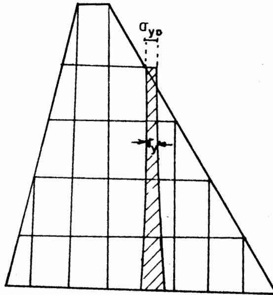
Fig. III.32 Esfuerzos normales en un plano vertical.
