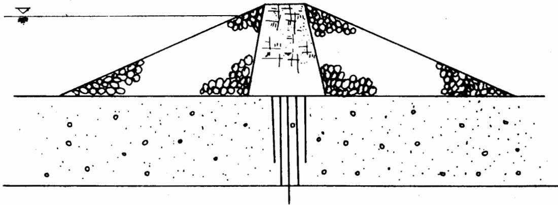
Fig II.17 Pantalla de Inyección
