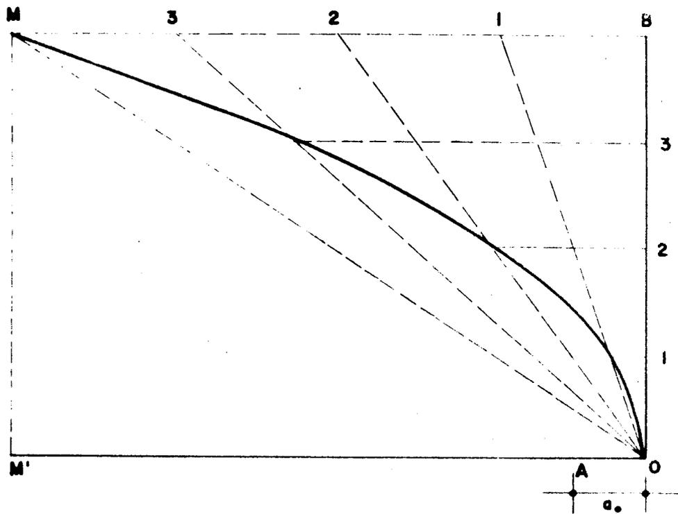
Fig II.37 Método para el trazo de la parábola básica de Kozeny (o de cualquier parábola).
