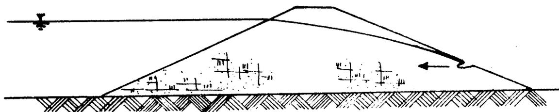
Fig II.29 Avance hacia el interior de la presa de un tubo.
