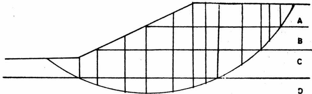
Fig II.45 División de dovelas de un suelo estratificado.
