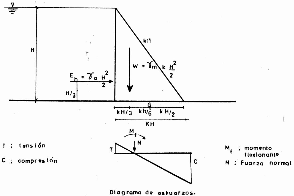
Fig. III.6 Muro sometido a empuje hidrostático y diagrama de esfuerzos.
