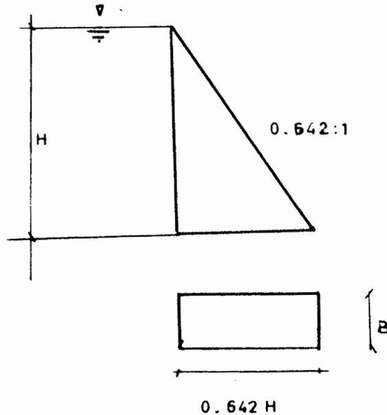
Fig. IV.3 Diagrama para una presa de gravedad sin subpresión.
