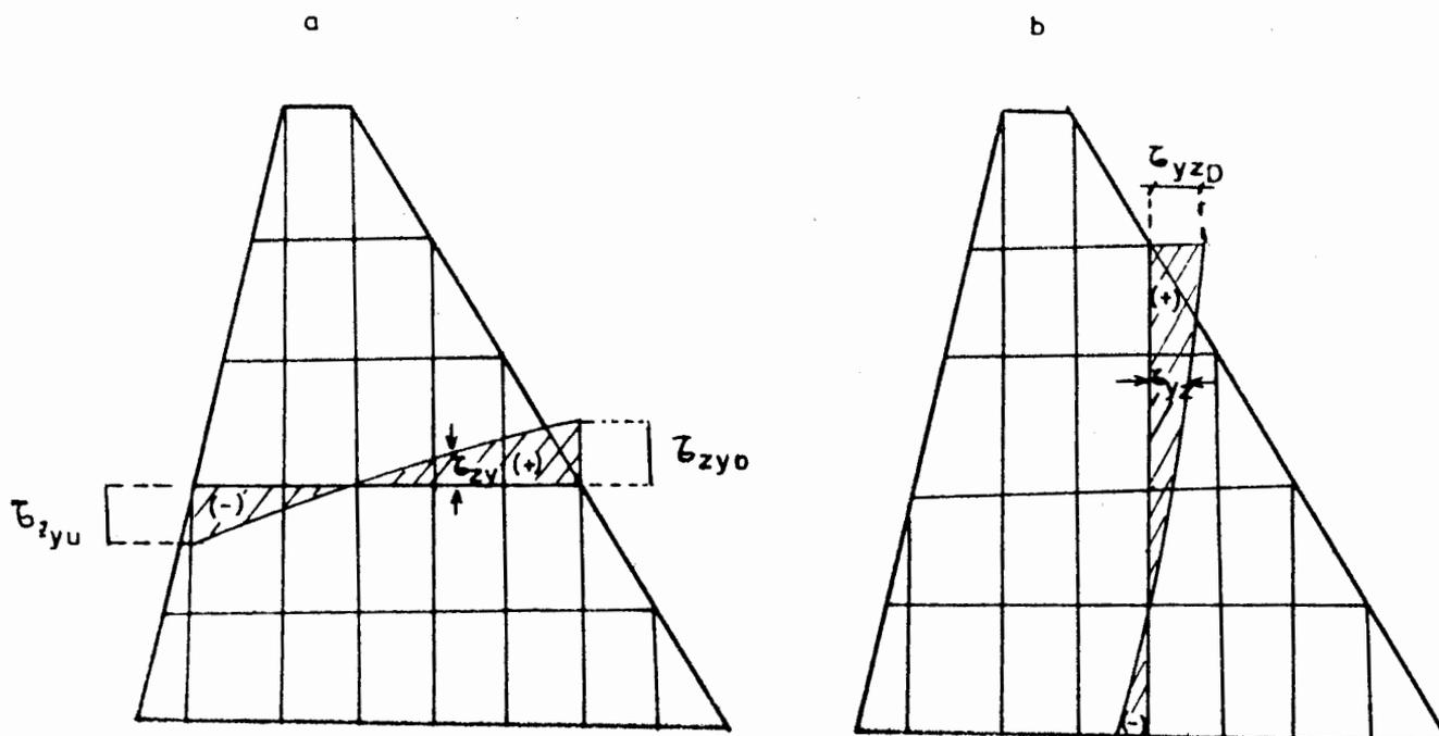
Fig. III.31 a) Esfuerzos cortantes en un plano horizontal.
