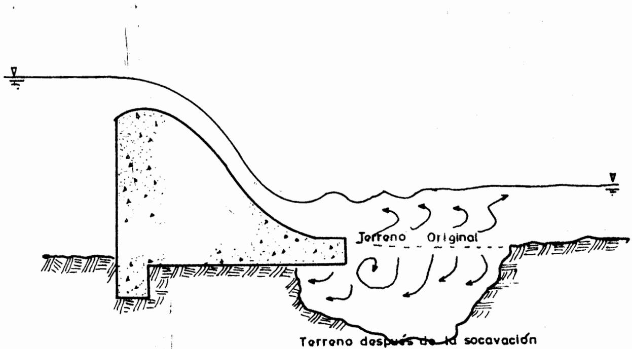
Fig VI.9 Socavación al pie de una presa vertedora.
