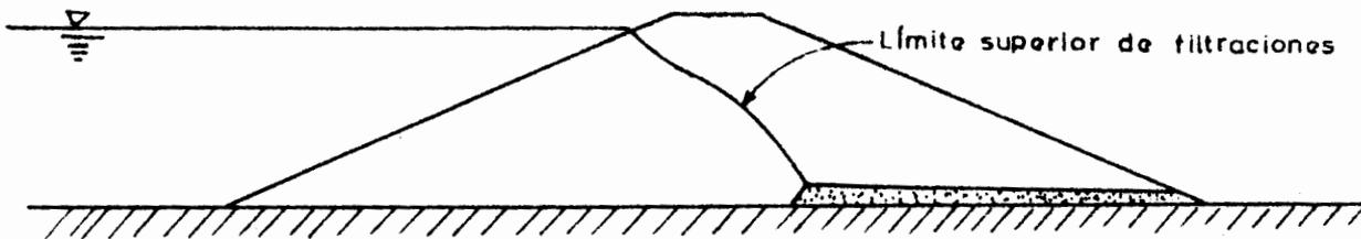
Fig II.5 Presa homogénea con filtro en delantal
