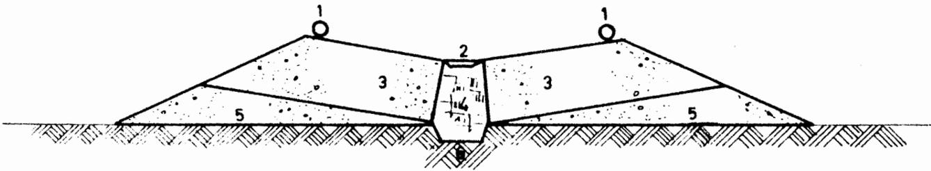
Fig II.1 Construcción de una presa de relleno hidráulico
