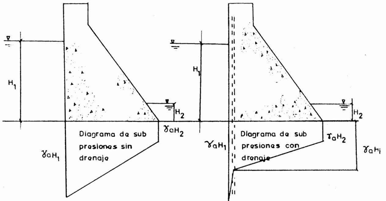
Fig. III.22 Diagramas de subpresión
