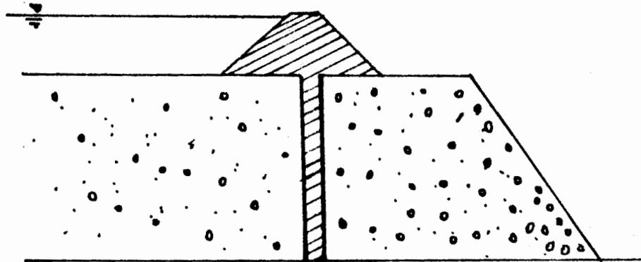
Fig II.57 Intercepción de filtraciones por medio de pantalla.
