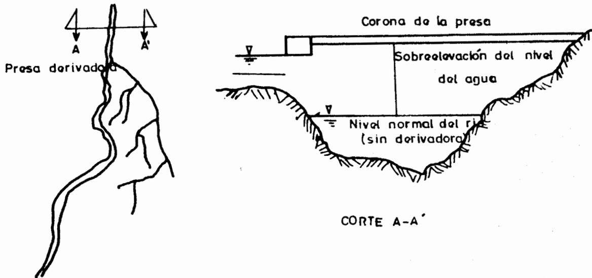
Fig VI.1 Planta y vista de una presa derivadora (esquemática).
