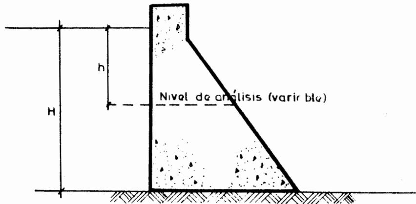
Fig. III.20 Variables que intervienen en el análisis del empuje del agua por sismo.
