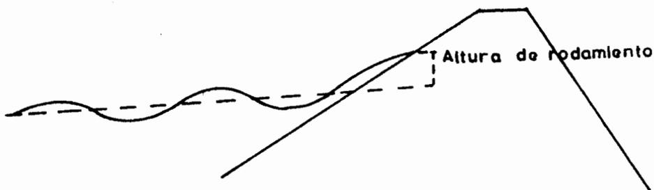
Fig II.27 Altura del rodamiento de una ola sobre el talud
