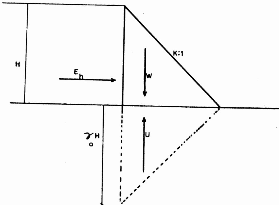
Fig. III.9 Diagrama de un muro con empuje hidrostático y con subpresión.
