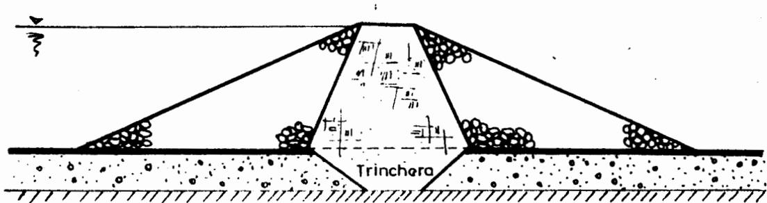
Fig II.15 Trinchera, cuando la profundidad de la cimentación lo permite
