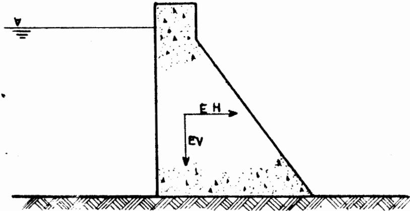
Fig. III.3 Deslizamiento de la presa.
