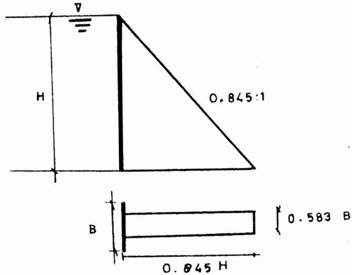
Fig. IV.4 Gueso de un contrafuerte, suprimida la subpresión.
