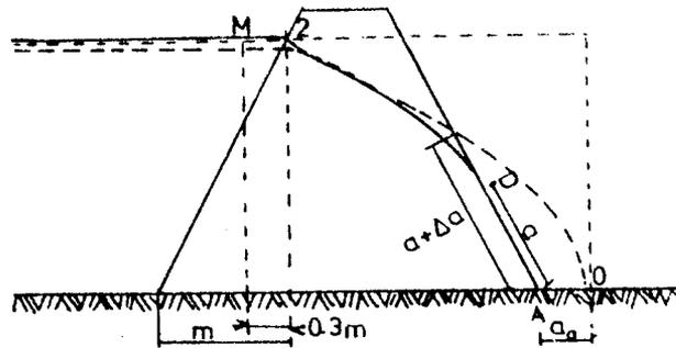
Fig II.38 Solución de A Casagrande para el punto D de salida.
