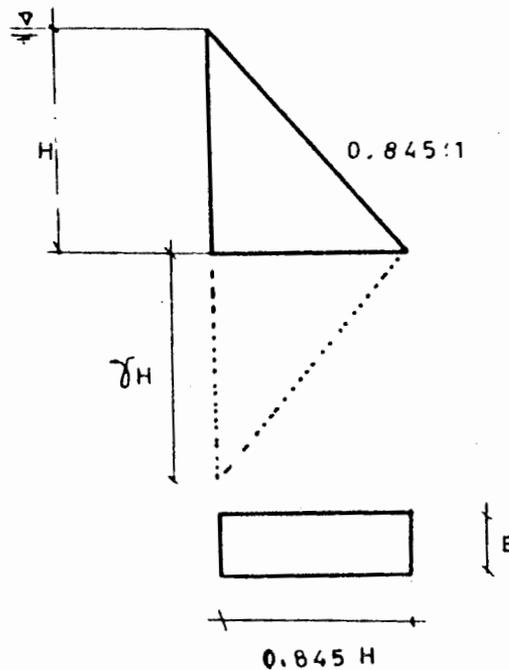
Fig. IV.2 Diagrama para una presa de gravedad con subpresión.
