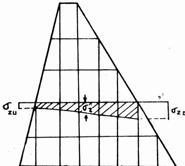
Fig. III.30 Esfuerzos normales en un plano horizontal.
