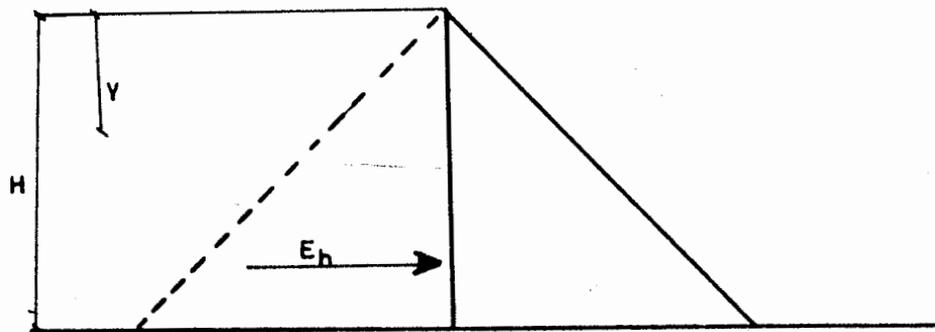
Fig. III.5 Muro triangular sometido a empuje hidrostático.
