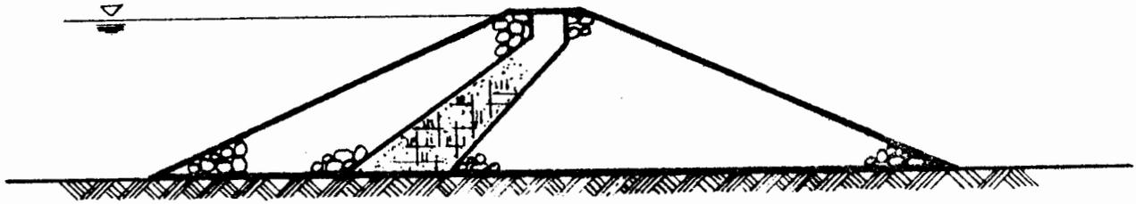
Fig II.13 Colocación inclinada del corazón impermeable.
