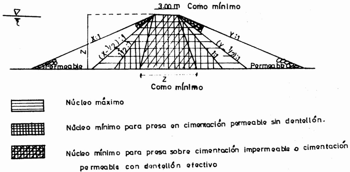
Fig II.11 Variación de tamaños de los núcleos impermeables en los terraplenes con puentes. U.S.B.R. (3)
