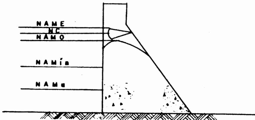
Fig. III.14 Niveles del agua característicos en una presa.
