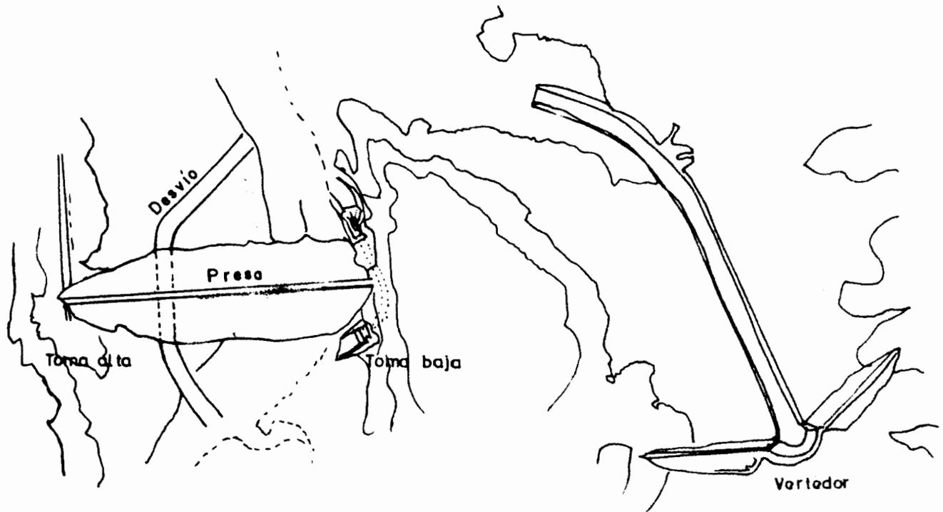
Fig I.2 Estructuras auxiliares de una presa
