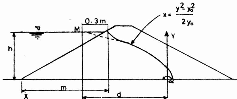
Fig II.35 Posición de la línea de corriente superior.
