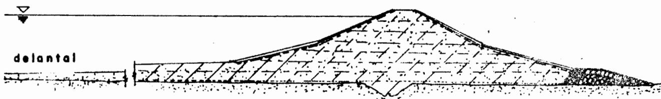
Fig II.16 Presa con delantal
