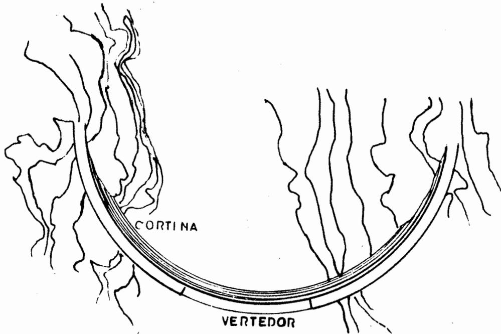
Fig. V.3 Presa de arco delgado.
