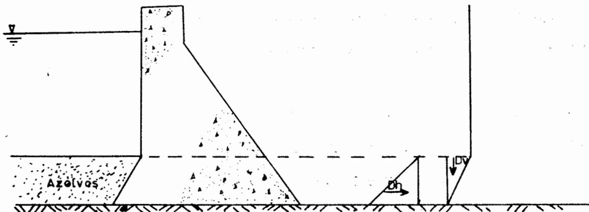
Fig. III.15 Empuje por azolvos en una presa de gravedad.
