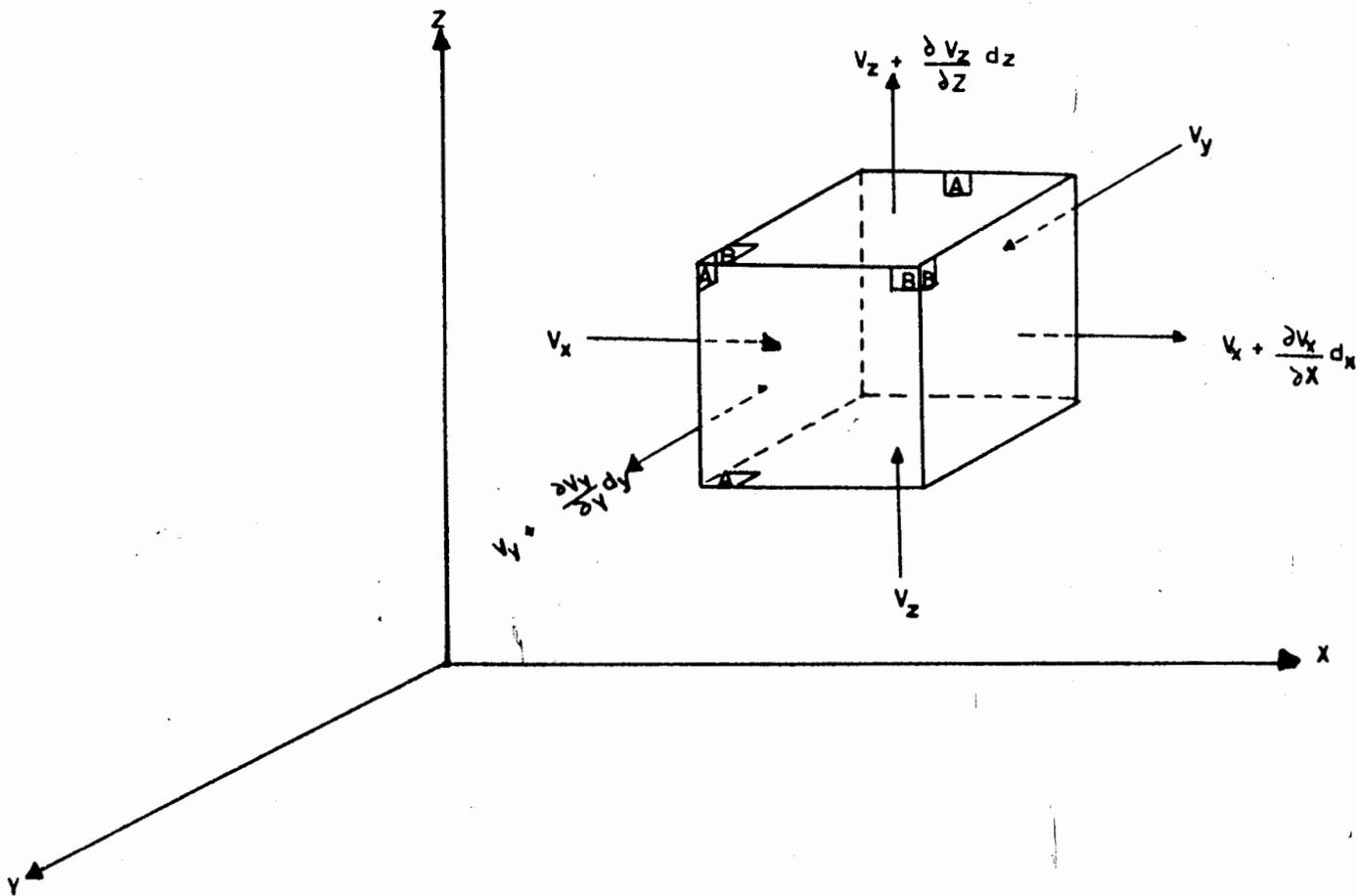
Fig II.30 Región sujeta a flujo tridimensional.
