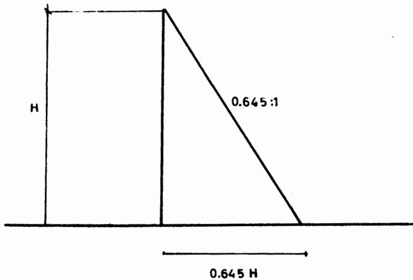
Fig. III.8 Talud mínimo para una presa sin sub presión.
