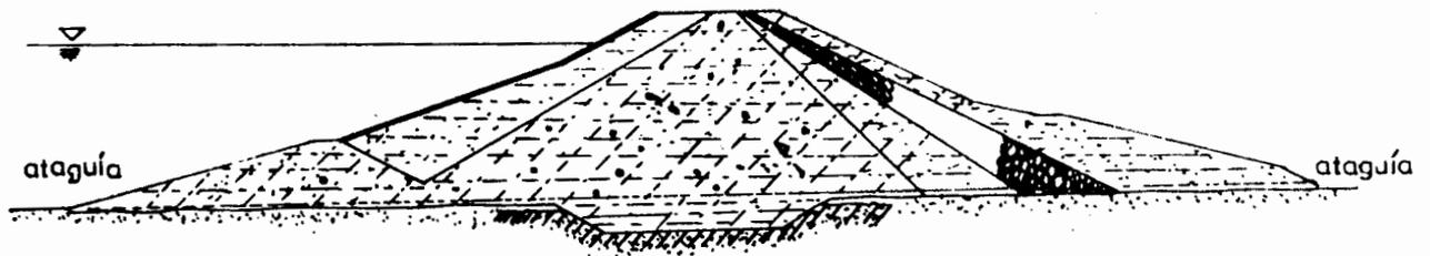
Fig II.22 Presa con ataguías integradas
