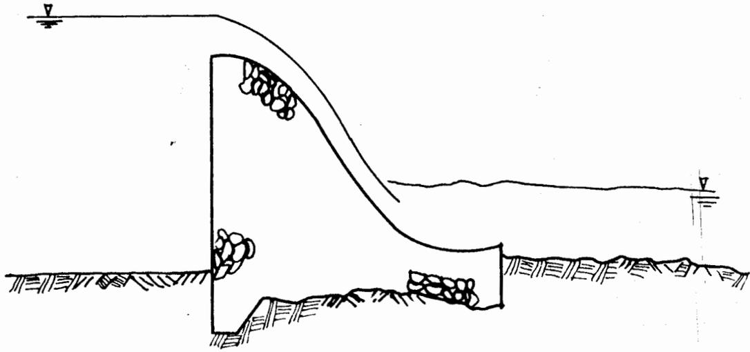
Fig VI.4 Presa derivadora de materiales cementados.
