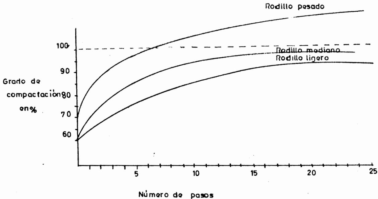
Fig II.41 Efecto del n\u00famero de pasadas de rodillo sobre el grado de compactaci\u00f3n.
