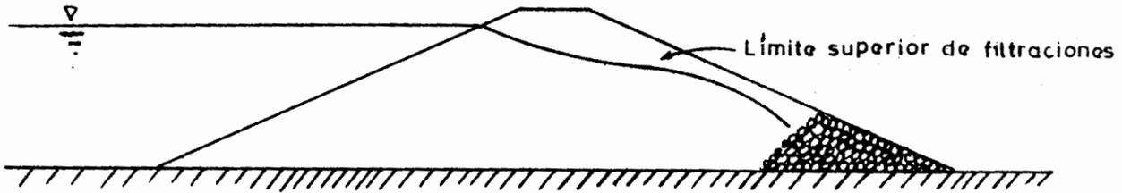
Fig II.4 Presa homogénea con filtro de pie de presa
