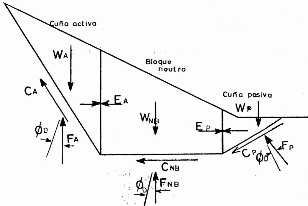
Fig II.51 Sección de falla dividida en tres cuñas.
