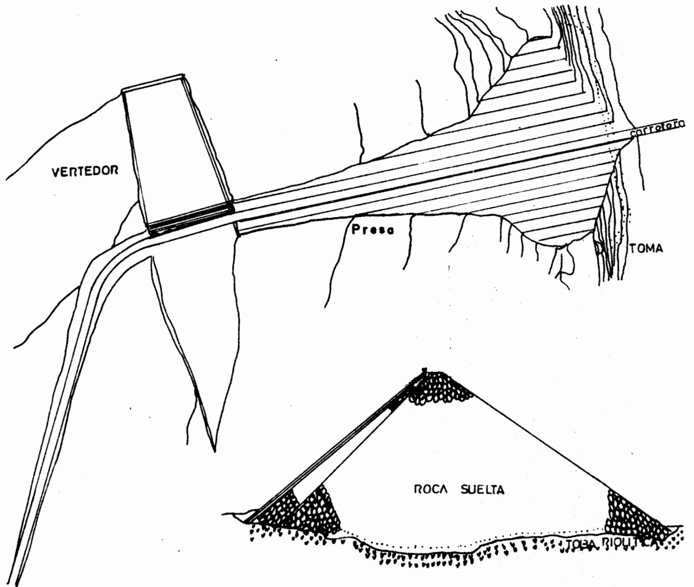
Fig II.7 Presa de enrocamiento
