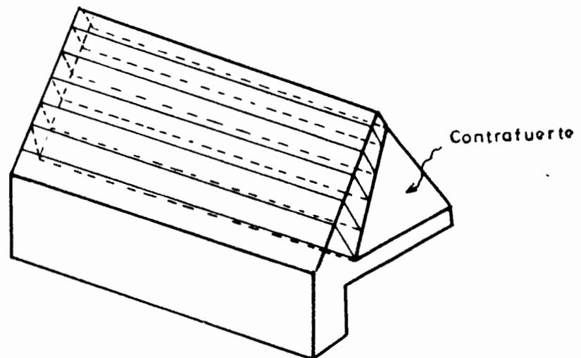
Fig. IV.8 Losa considerada que trabaja como una serie de vigas que corren entre los contrafuertes.
