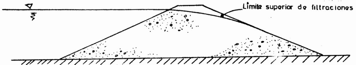
Fig II.3 Presa completamente homogénea
