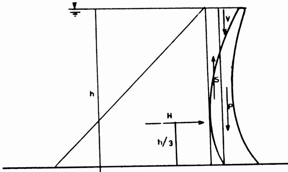
Fig. V.8 Empuje sobre un elemento vertical de una presa de arco.
