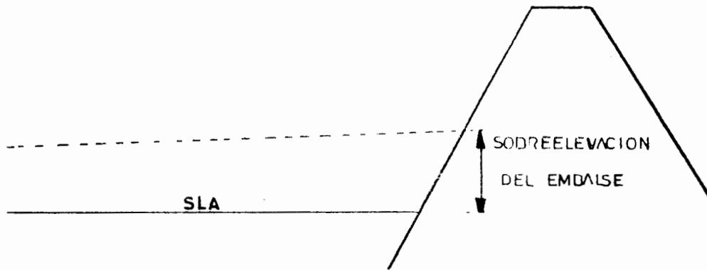
Fig II.24 Sobreelevación del embalse por efecto del viento
