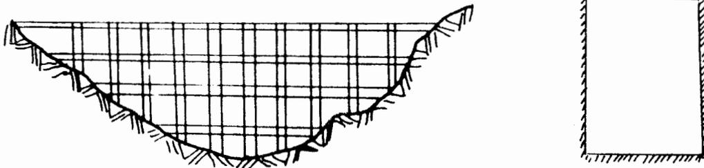
Fig. III.35 Tratamiento de una cortina por el método trial load.
