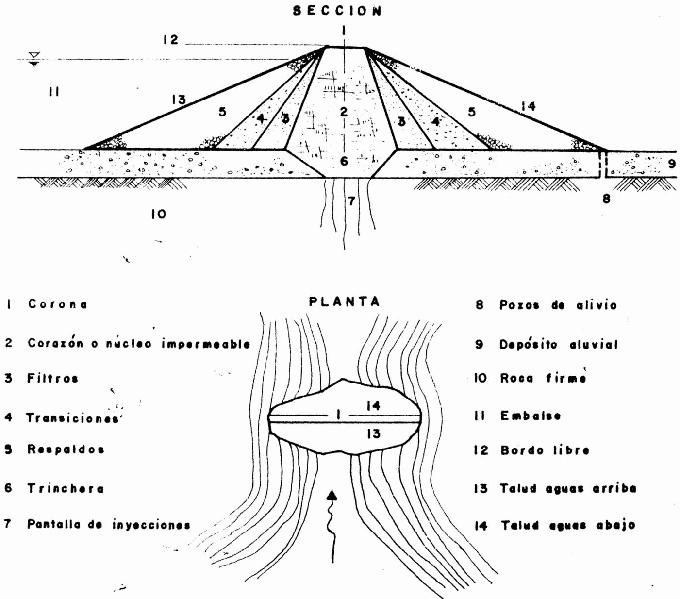
Fig I.3 Presa de materiales graduados, tomada de la referencia (1).
