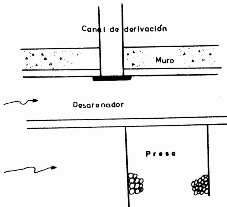
Fig VI.12 Planta de una obra de toma.
