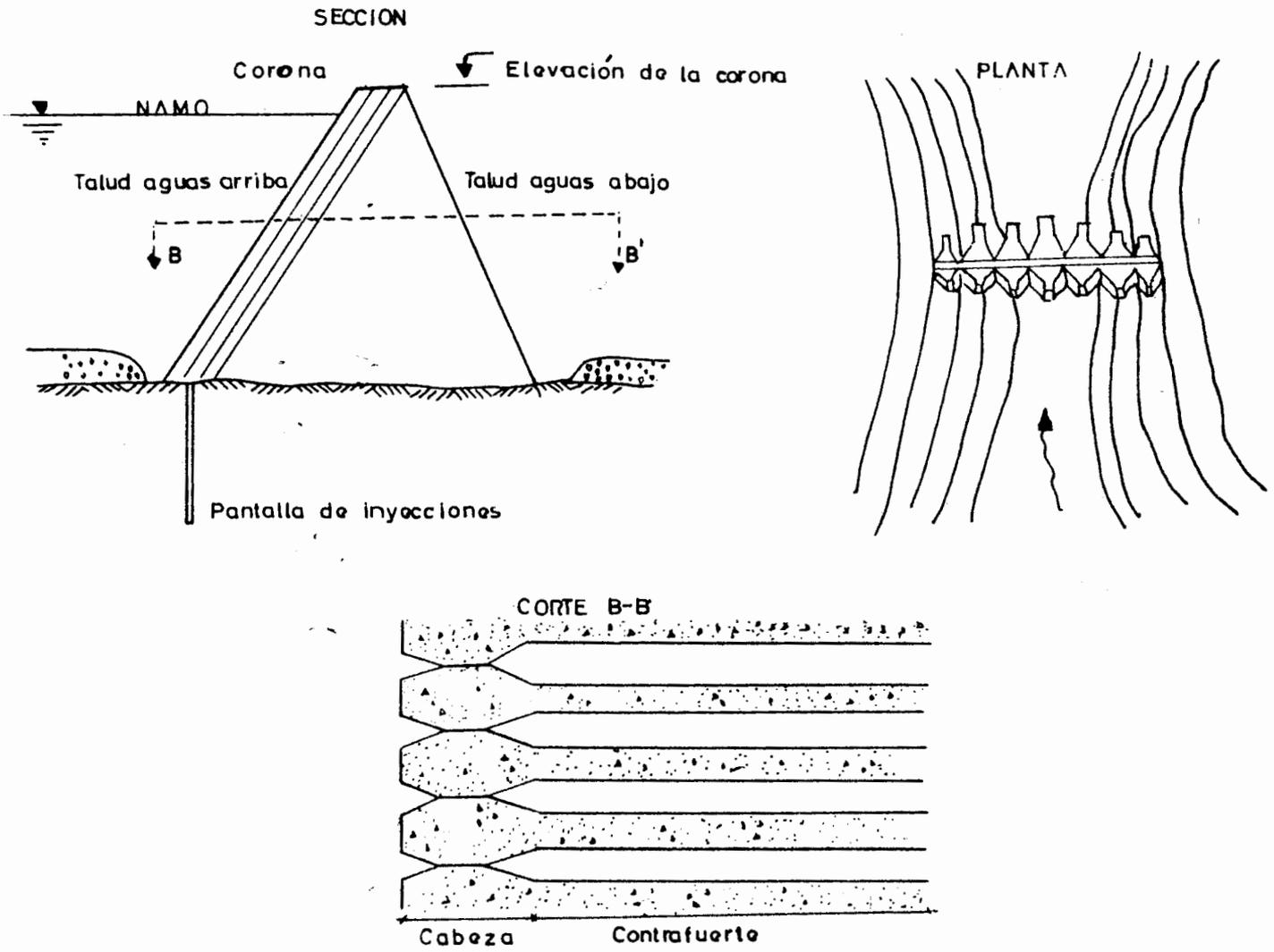
Fig 1.5 Presa de contrafuertes
