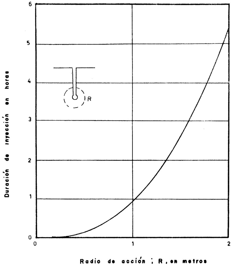
Fig II.18 Avance de la inyección en función del tiempo.
