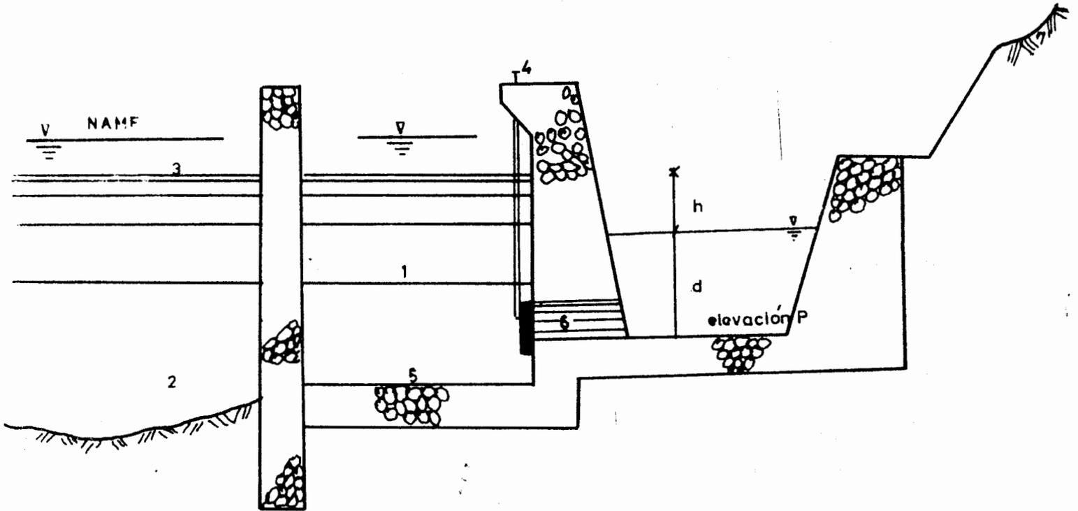
1. Compuerta radial del desarenador
