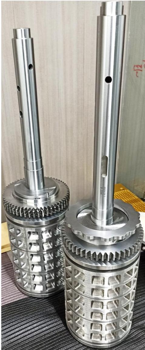
Imagen 22. Comprobación de correcto ensamblaje de flechas y rodillos de sellado nuevos.
