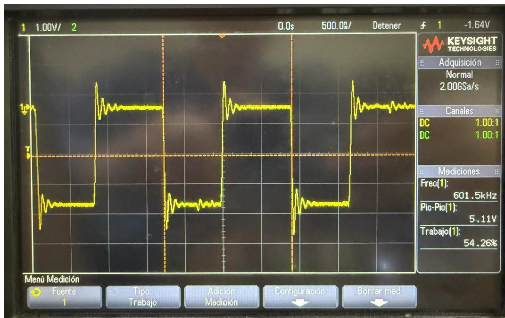
Figura 85. Señal de sincronización para el regulador de 12[V]
