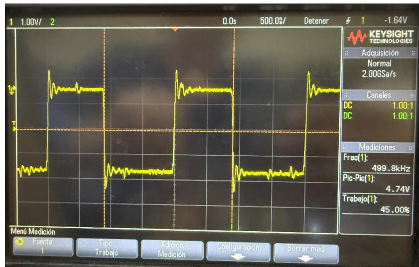
Figura 83. Señal de sincronización para el regulador de 5[V]
