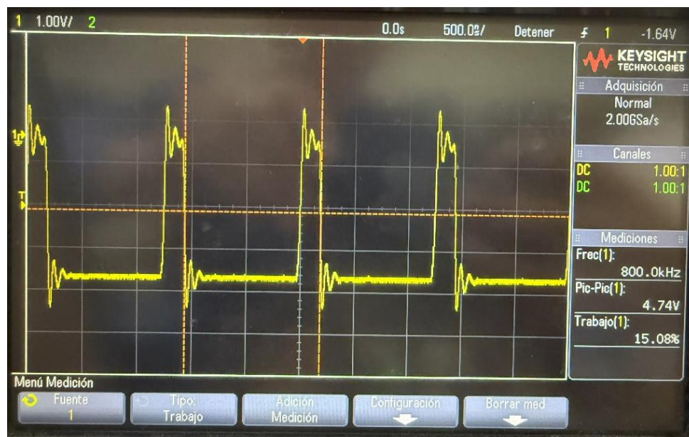
Figura 84. Señal de sincronización para el regulador de 3.3[V].
