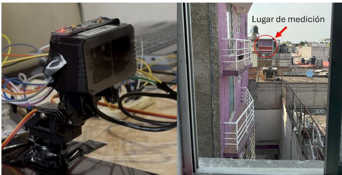
Figura 81. (izq.) Sensores colocados en el mecanismo de movimiento; (dcha.) Edificio donde se midió una distancia de 24.7[m].
