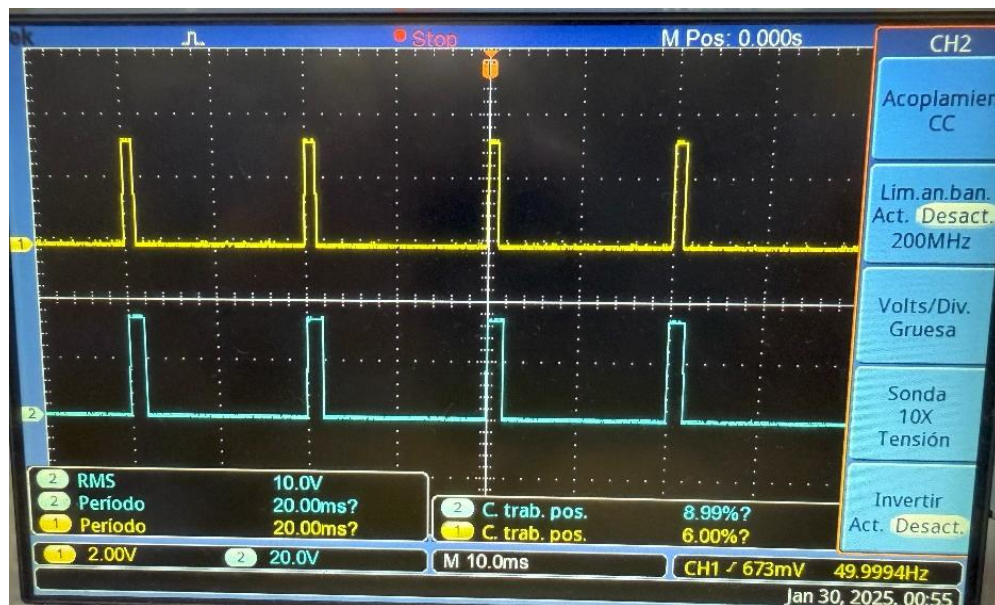
Figura 70. Señales de control de los servomotores: a) Amarillo-Horizontal; b) Azul-Vertical
