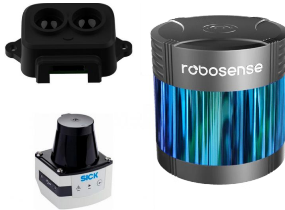
Figura 10. Diferentes tipos de LIDAR: 1D (izquierda superior), 2D (izquierda inferior) y 3D (derecha).
