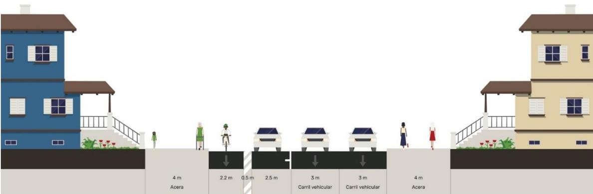
**Figura 3.7. Ciclovía unidireccional con cordón de estacionamiento**
