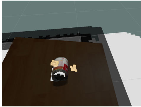
Figura 4.2: Distribución de agarres aproximada para el objeto 005_tomato_soup_can
