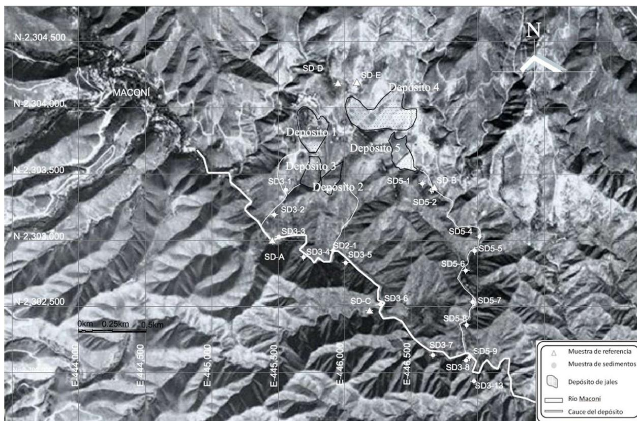
Figura 3. Ubicación de los depósitos de jales; se observa los cinco depósitos y la ubicación de las muestras a lo largo de los cauces y sobre el río Maconí. También se presentan los puntos de las muestras de referencia, así como la localidad de Maconí.
