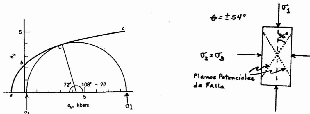
Figura 72. EJEMPLO DEL USO DE LA ENVOLVENTE DE MOHR PARA DETERMINAR EL MOMENTO EN QUE OCURRE RUPTURA EN UNA MUESTRA DE ROCA Y EL ANGULO, RESPECTO A  $\sigma_1$ , EN QUE SE DESARROLLARA EL PLANO DE FALLAMIENTO. LA CURVA a, b, c, ES LA ENVOLVENTE DE MOHR. LA PRESION CONFINANTE ES IGUAL A 0.2 KBARES.
