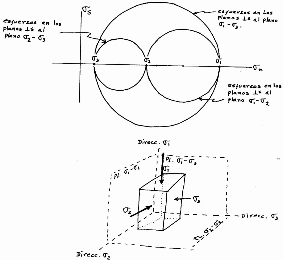
Figura 34. . CIRCULOS DE MOHR REPRESENTANDO UN ESTADO TRI-DIMENSIONAL DE ESFUERZOS EN EL CUAL  $\sigma_1 > \sigma_2 > \sigma_3$ . EL CIRCULO MAYOR REPRESENTA LOS ESFUERZOS EN LOS PLANOS PERPENDICULARES AL PLANO FORMADO POR  $\sigma_1$  Y  $\sigma_3$ . LOS CIRCULOS INTERMEDIO Y MENOR, REPRESENTAN RESPECTIVAMENTE, LOS ESFUERZOS PERPENDICULARES A LOS PLANOS FORMADOS POR  $\sigma_1, \sigma_2$  Y POR  $\sigma_2, \sigma_3$ .
