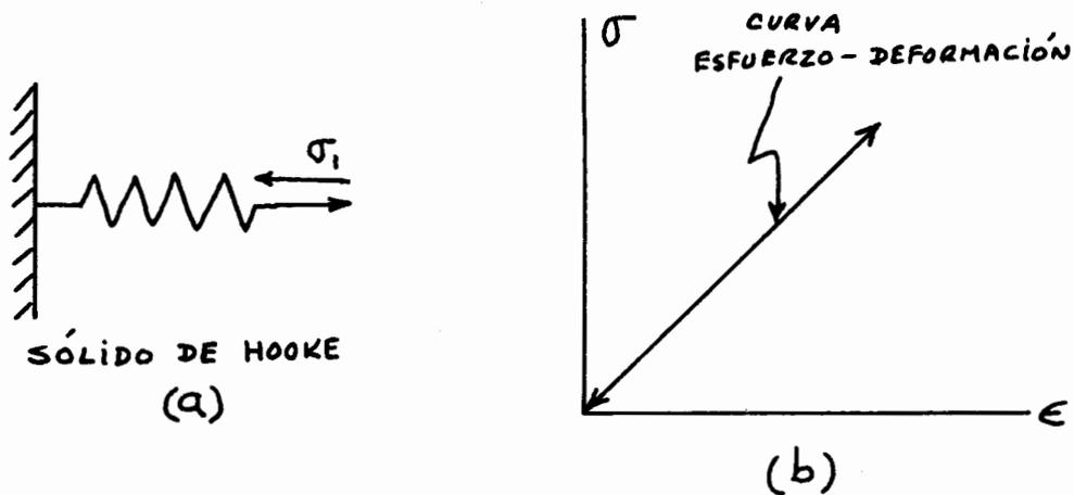
Figura 62. (a) MODELO REOLOGICO PARA UN MATERIAL ELASTICO ISOTROPICO. (b) RELACION ESFUERZO-DEFORMACION PARA ESTE TIPO DE MATERIAL.
