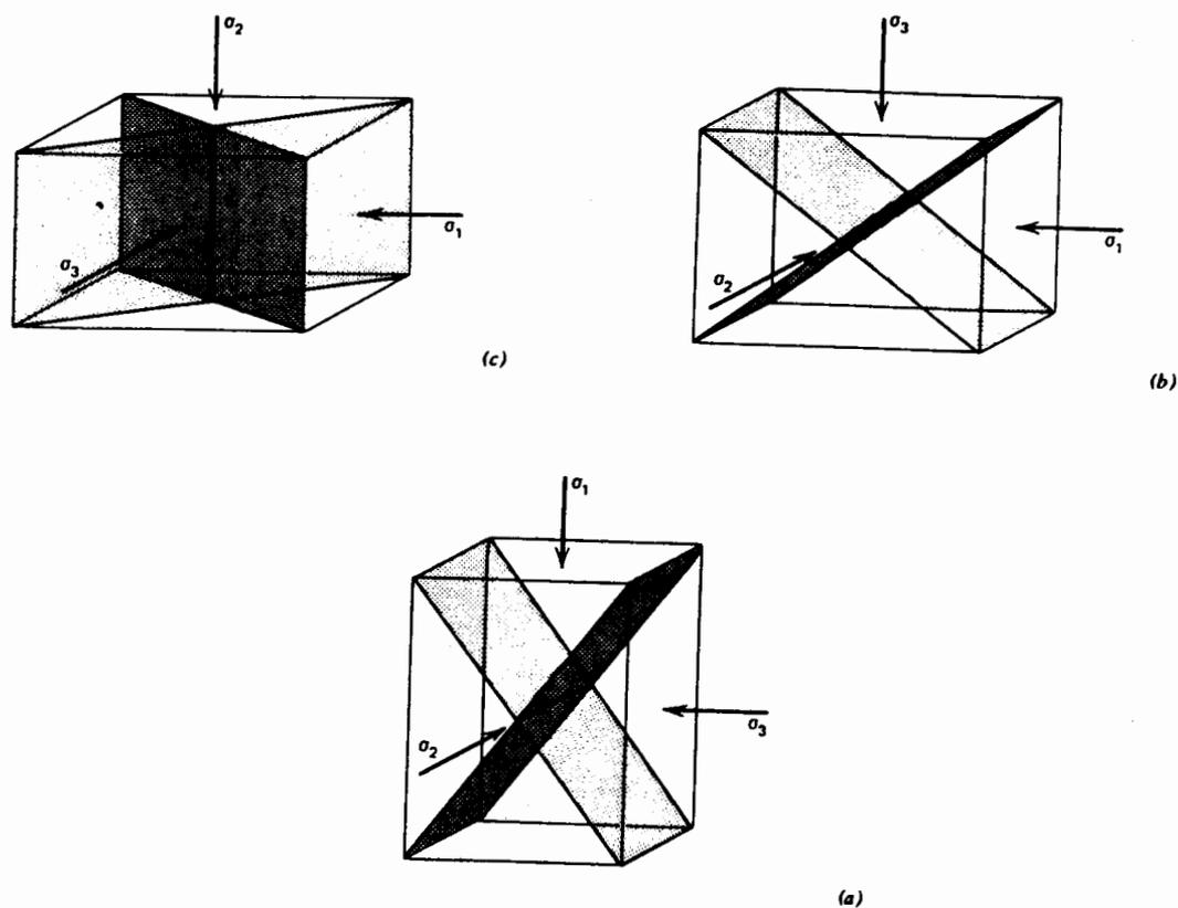
Figura 78. PLANOS DE FALLA POTENCIALES PARA UNA ROCA ISOTOPICA CUANDO ALGUNO DE LOS ESFUERZOS PRINCIPALES ES VERTICAL. (a) FALLAS NORMALES, (b) FALLAS INVERSAS Y (c) FALLAS DE TRANSCURRENCIA.
