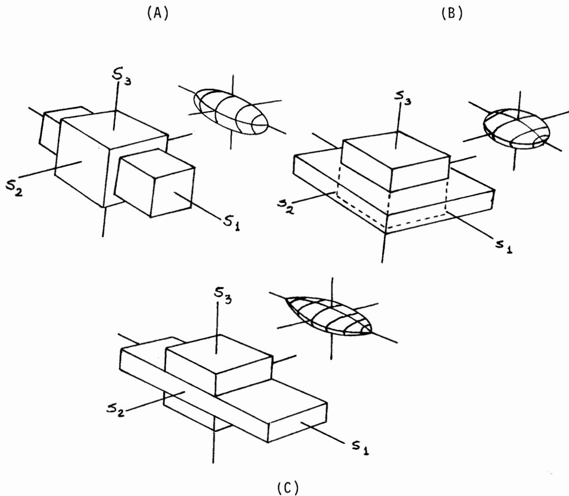
Figura 45 . TIPOS ESPECIALES DE DEFORMACION HOMOGENEA. (A) EXTENSIÓN SIMÉTRICA AXIAL; (B) ACORTAMIENTO SIMÉTRICO AXIAL; (C) DEFORMACION PLANAR.
