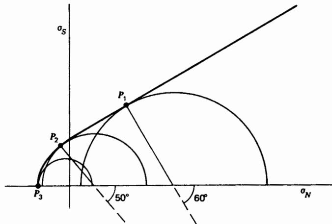
Figura 77. CORRELACION ENTRE LA ORIENTACION DE LAS FRACTURAS Y LA ENVOLVENTE DE MOHR.
