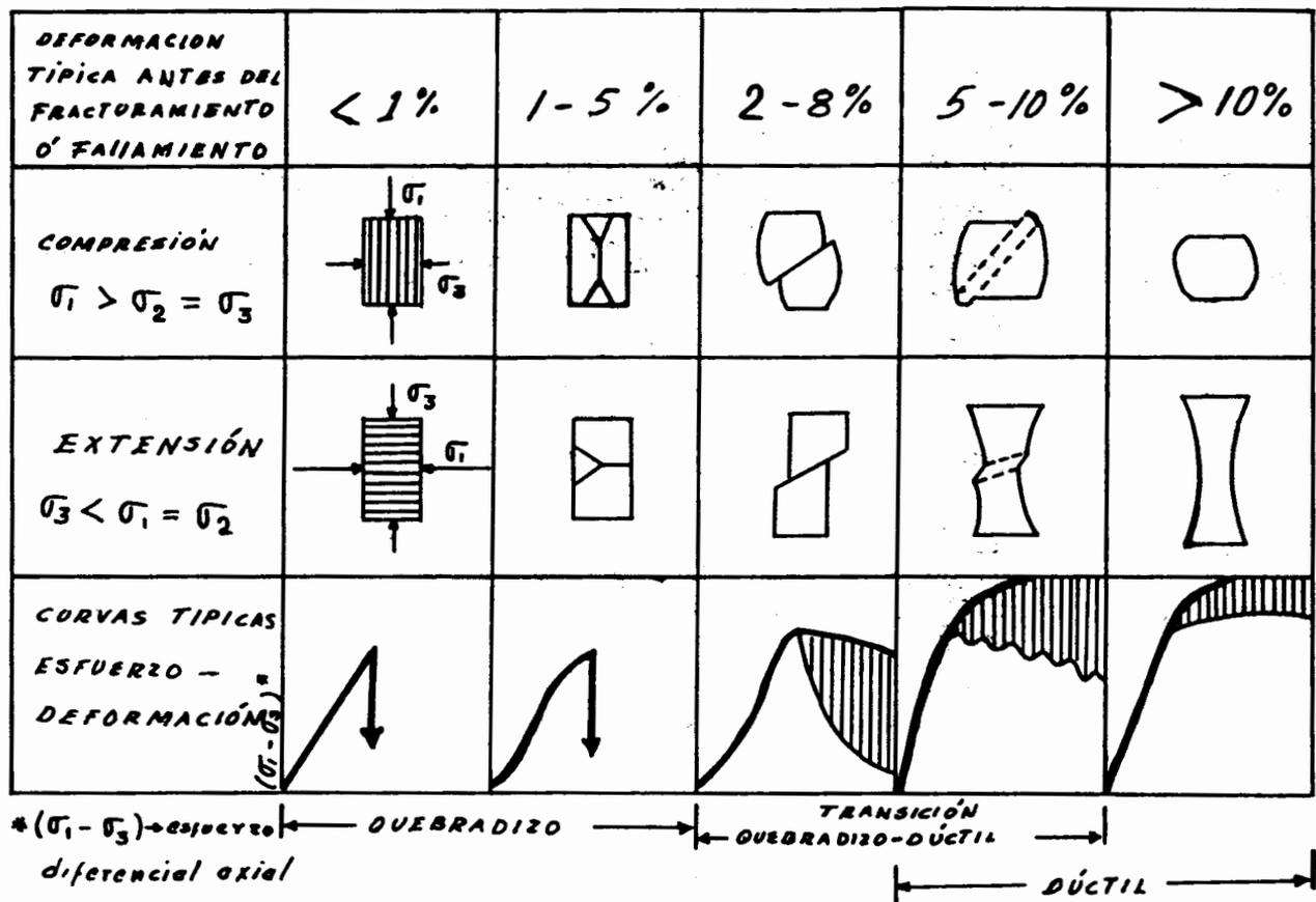
Figura 68. DIFERENTES COMPORTAMIENTOS DE ROCAS SOMETIDAS A PRUEBAS TRIAXIALES (SEGUN GRIGGS Y HANDIN, 1960).
