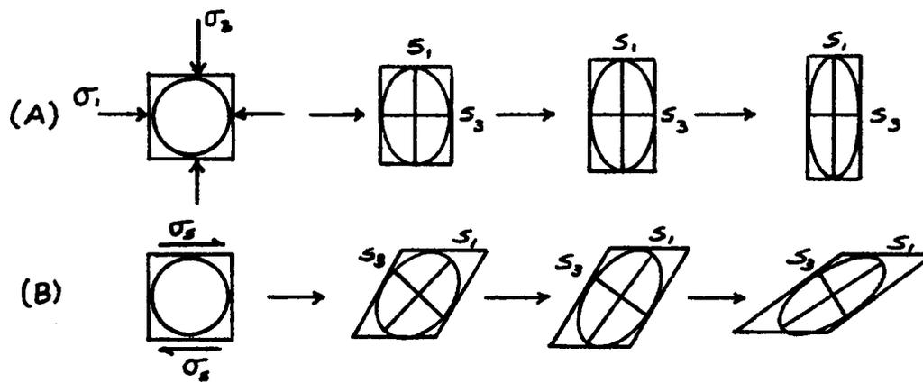
Figura 41. (A) CIZALLA PURA O DEFORMACION IRROTACIONAL. (B) CIZALLA SIMPLE O DEFORMACION ROTACIONAL.
