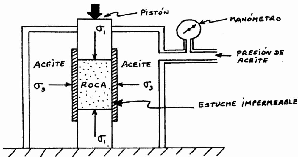
Figura 67. ESQUEMA DE UNA CAMARA HIDROSTATICA PARA PRUEBAS TRIAXIALES.
