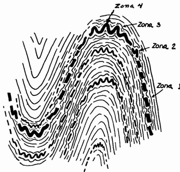
Figura 49. DESARROLLO ZONAL DE ESTRUCTURAS EN UN PLIEGUE SIMPLE. SEGUN RAMSAY (1967).
