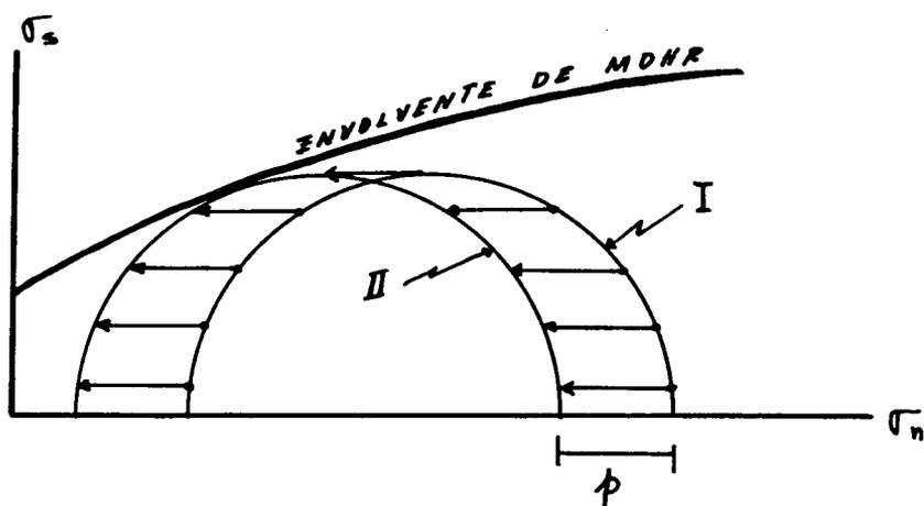
Figura 73. DIAGRAMA DE MOHR EN EL QUE SE GRAFICA EL ESFUERZO NORMAL EFECTIVO CONTRA EL ESFUERZO DE CIZALLA. EL CIRCULO I REPRESENTA EL ESTADO DE ESFUERZO PARA UNA ROCA ESTABLE CUANDO  $p=0$ , MIENTRAS QUE EL CIRCULO II REPRESENTA EL ESTADO DE ESFUERZO PARA UNA ROCA INESTABLE CUANDO LA PRESION INTERSTICIAL HA SIDO INCREMENTADA.
