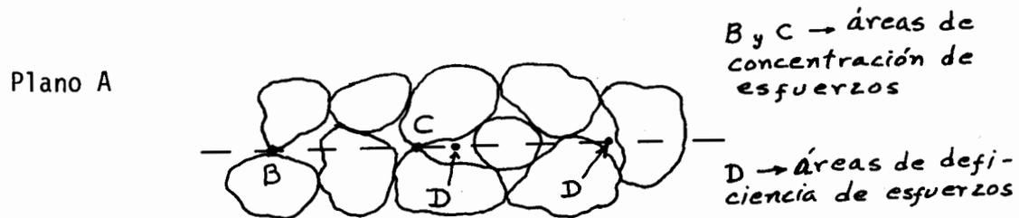
Figura 11 MICROESTRUCTURA DE LA ARENISCA DE LA FIGURA ANTERIOR.
