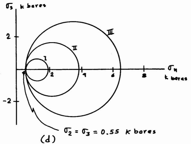
Figura 69. PRUEBA TRIAXIAL PARA UN ESPECIMEN DE ROCA. VER TEXTO PARA DISCUSION.
