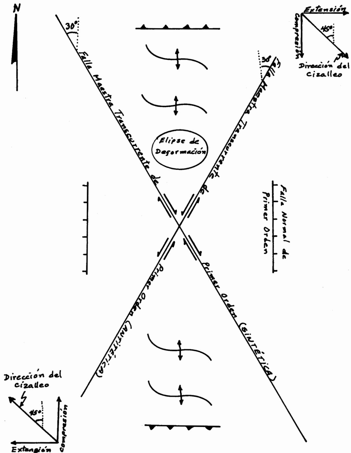
Figura 82. ESTRUCTURAS TEORICAS PRODUCIDAS POR UN CIZALLEO ORIENTADO 45°NW-SE (CIZALLA SIMPLE)
