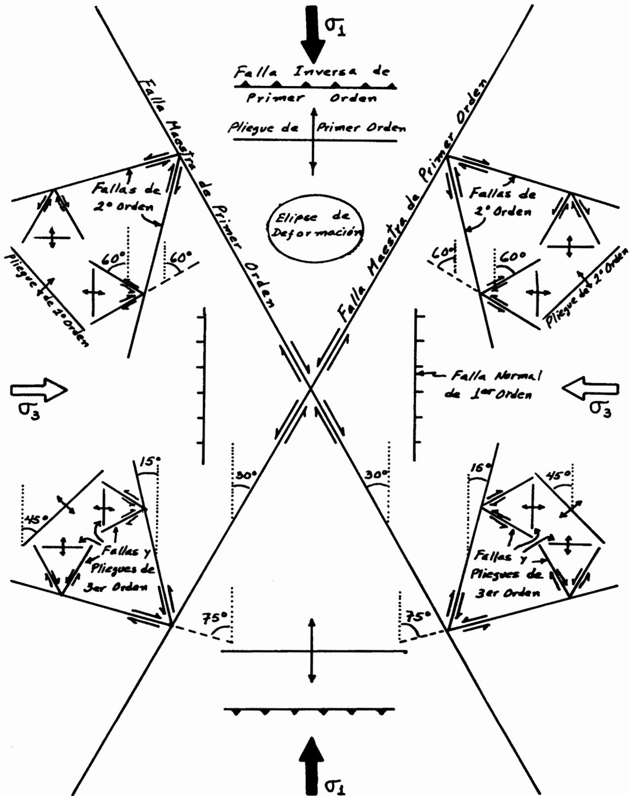
Figura 81. ORIENTACION TEORICA DE ESTRUCTURAS PRODUCIDAS POR CIZALLA PURA EN UN MEDIO HOMOGENEO
