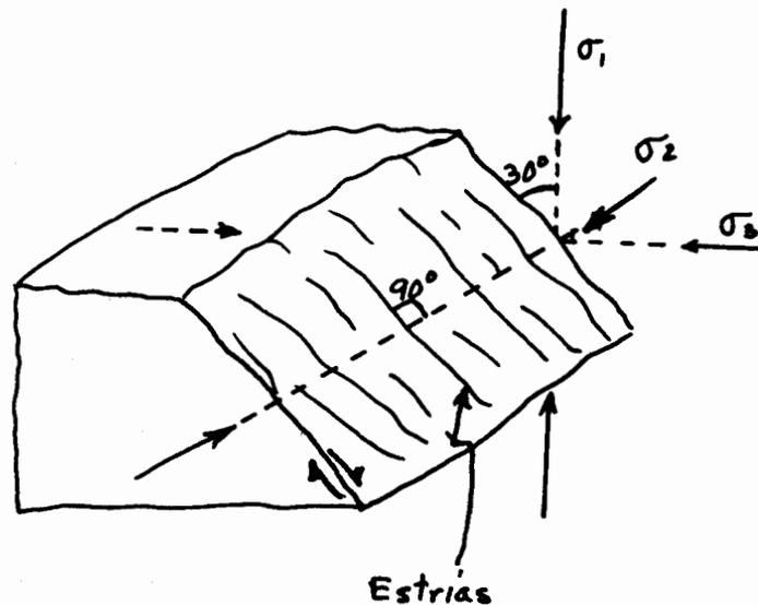
Figura 80. ESQUEMA MOSTRANDO LA POSIBLE ORIENTACION DE LOS ESFUERZOS PRINCIPALES EN UN PLANO DE FALLA.
