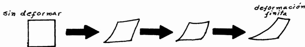
Figura 47. EJEMPLO DE DEFORMACION PROGRESIVA
