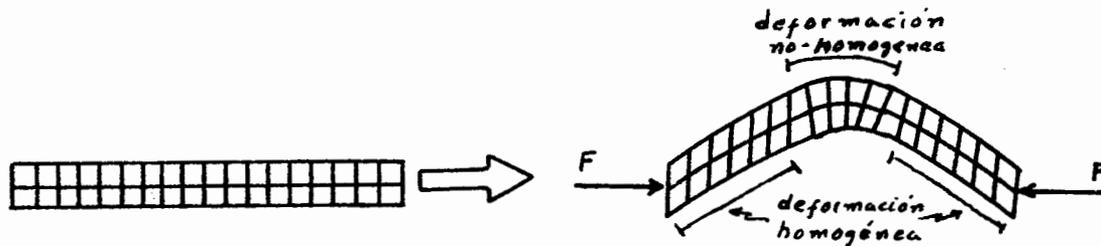
Figura 37. DIFERENTES TIPOS DE DEFORMACION PRESENTES EN UNA CAPA CUANDO ES PLEGADA.
