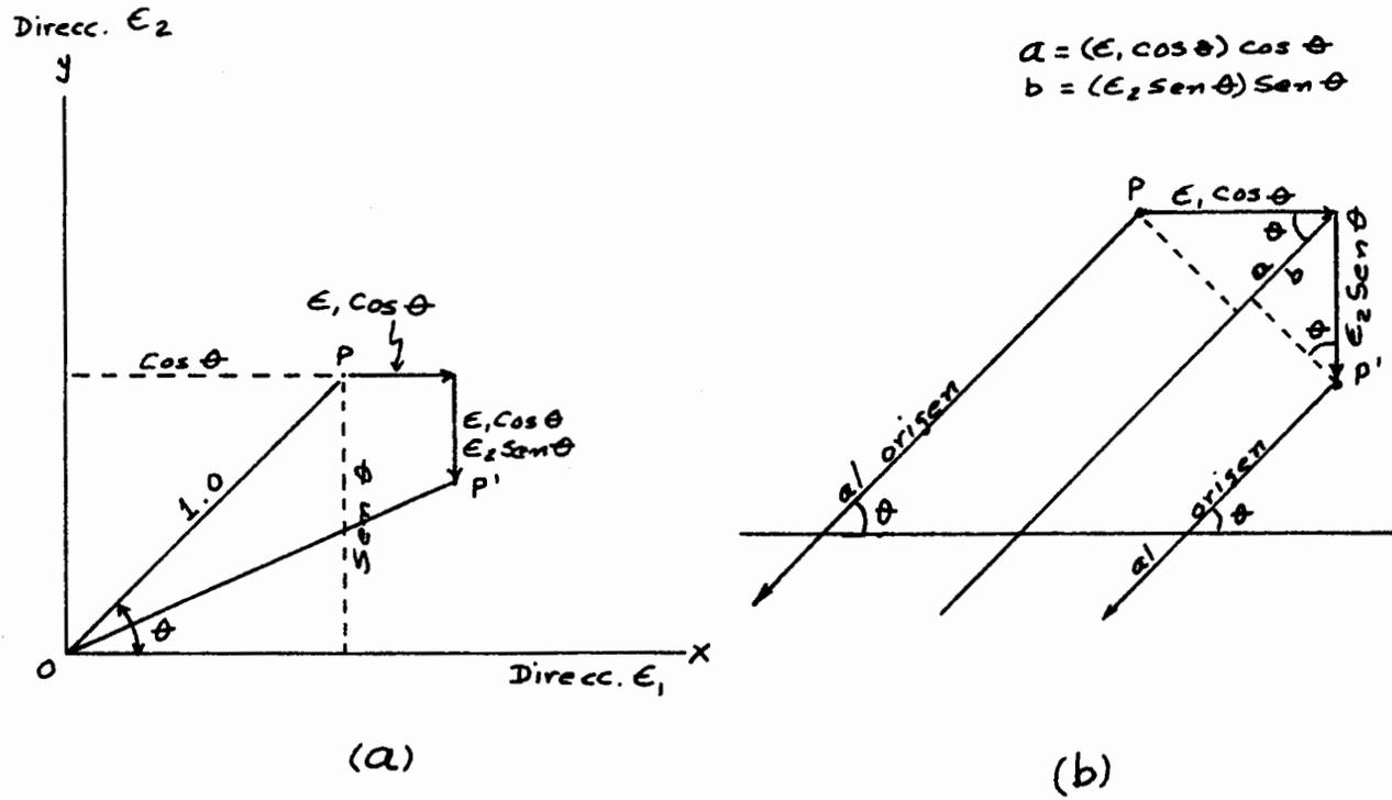
Figura 50. CALCULO DE LA ELONGACION PARA UNA LINEA INCLINADA  $\theta$  GRADOS DE LA DIRECCION  $E_1$ .
