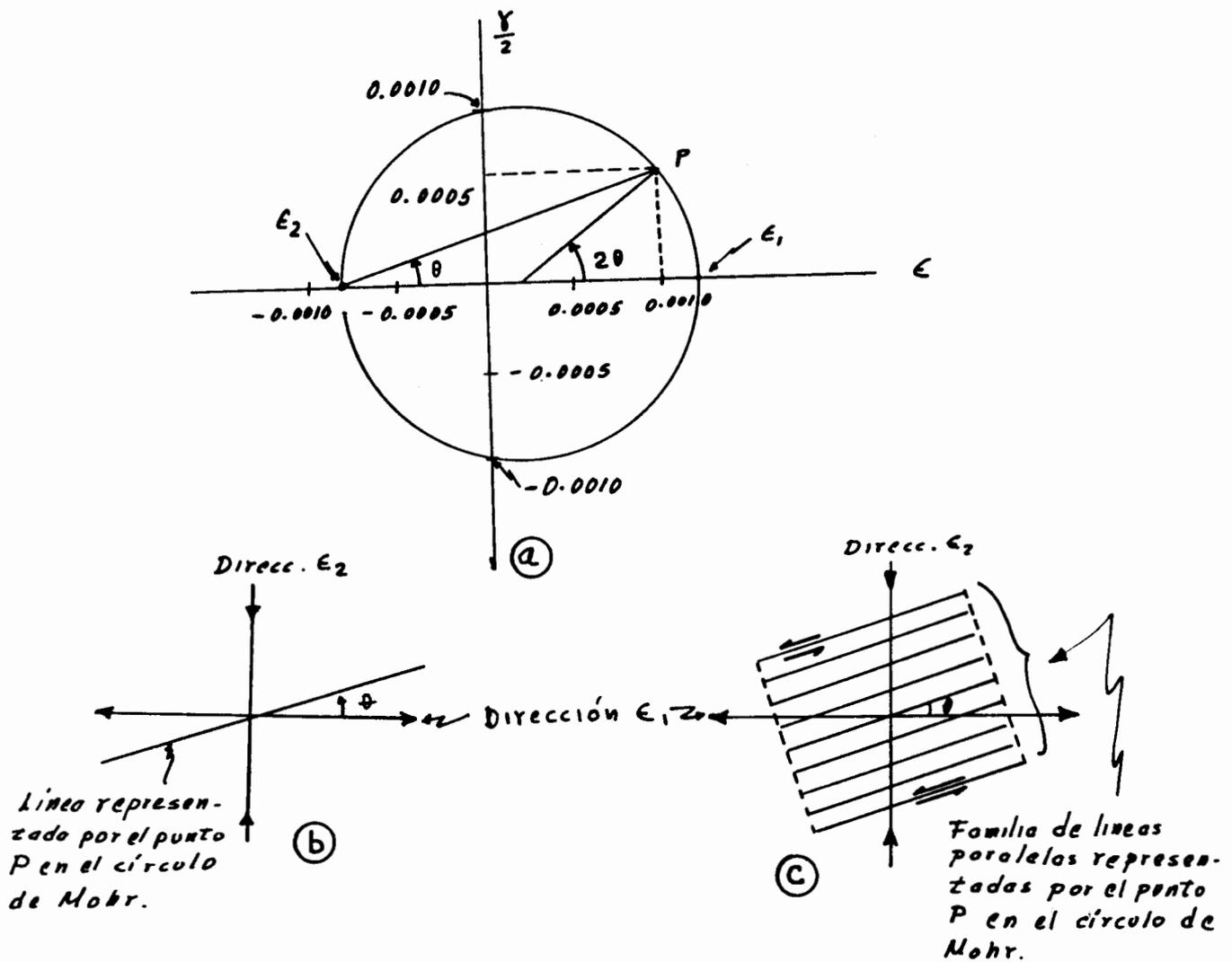
Figura 51. EJEMPLO DEL USO DEL CÍRCULO DE MOHR PARA DEFORMACIONES INFINITESIMALES.
