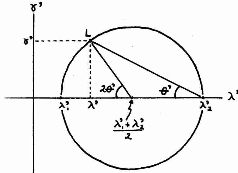
Figura 55. CIRCULO DE MOHR PARA DEFORMACION FINITA.
