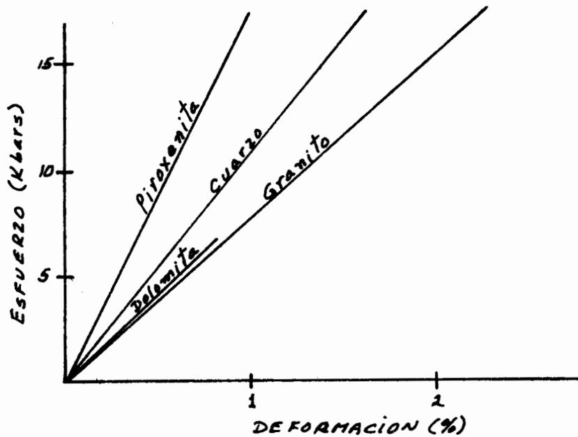
Figura 63. COMPORTAMIENTO DE ROCAS Y MINERALES APROXIMADAMENTE ELASTICOS CUANDO SON SOMETIDOS A CARGAS AXIALES.
