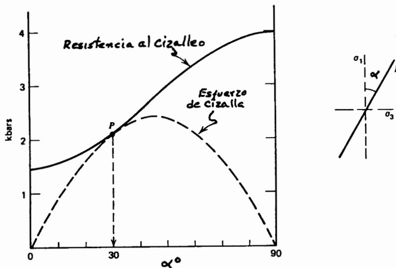
Figura 76. PRUEBA DE RESISTENCIA AL CIZALLEO Y ESFUERZO DE CIZALLA PARA EL MOMENTO PREVIO AL FRACTURAMIENTO PARA PLANOS PARALELOS A  $\sigma_2$  E INCLINADOS  $\alpha^\circ$  CON RESPECTO A  $\sigma_1$ . PARA DISCUSION VER TEXTO.
