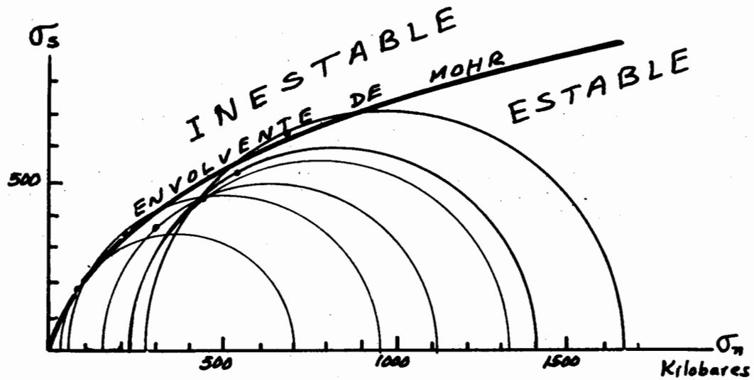
Figura 70. CIRCULOS DE MOHR PARA UNA MARGA DEFORMADA A DIFERENTES PRESIONES CONFINANTES. EL PUNTO EN CADA CIRCULO REPRESENTA EL MOMENTO EN QUE OCURRE RUPTURA.
