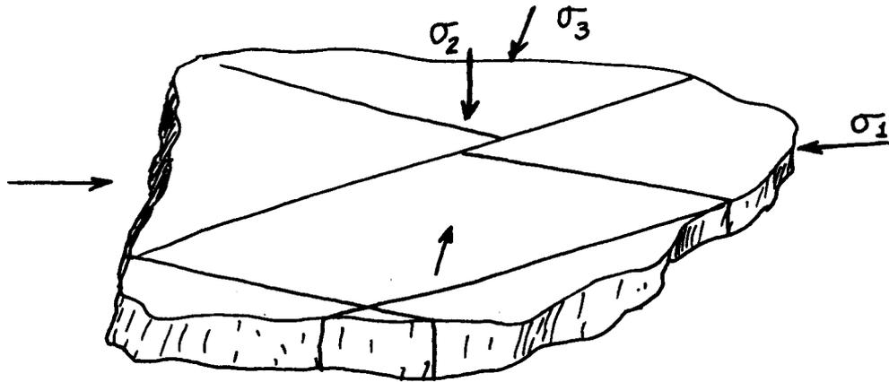
Figura 79. ESQUEMA MOSTRANDO LA POSIBLE ORIENTACION DE LOS ESFUERZOS PRINCIPALES EN UNA MUESTRA DE ROCA.
