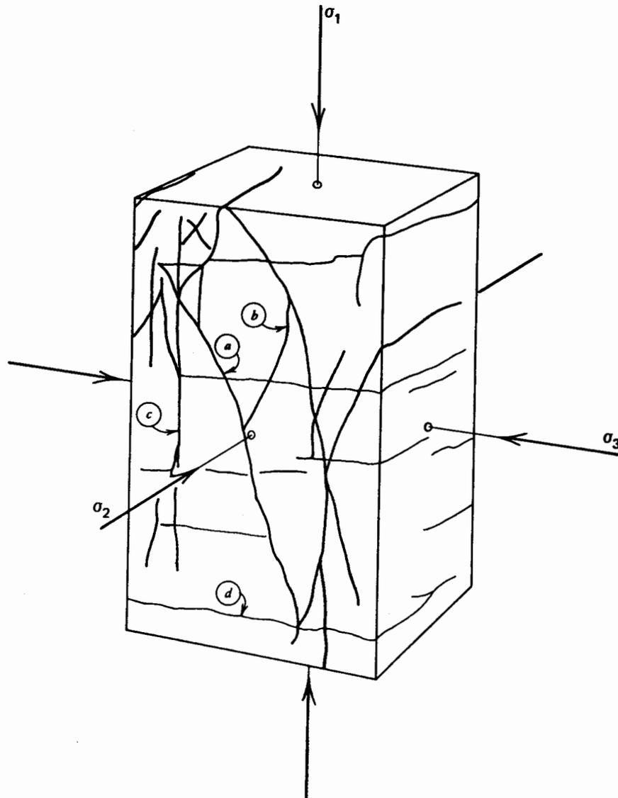
Figura 75. FRACTURAS FORMADAS EXPERIMENTALMENTE EN UN BLOQUE DE CALIZA DE SOLENHAFEN.  $\sigma_1 > \sigma_2 > \sigma_3$ . PARA DISCUSION VER TEXTO.
