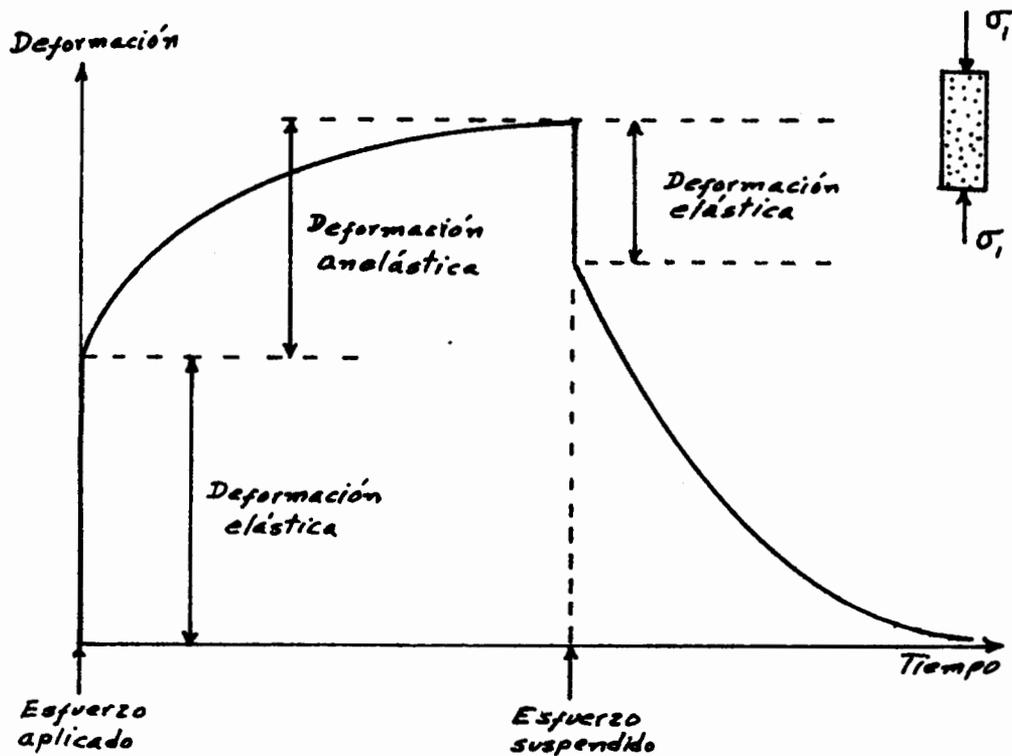
Figura 64. GRAFICA MOSTRANDO LOS DIFERENTES COMPORTAMIENTOS DE UNA ROCA APROXIMADAMENTE ELASTICA CUANDO ES DEFORMADA DURANTE PERIODOS PROLONGADOS DE TIEMPO.
