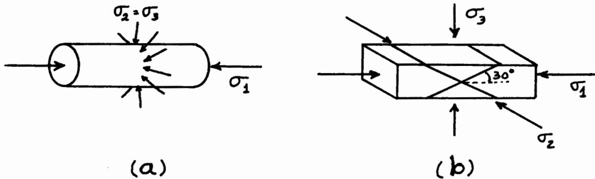
Figura 74. (a) CILINDRO DE ROCA SOMETIDO A UN ESTADO DE ESFUERZO EN DONDE  $\sigma_1 > \sigma_2 = \sigma_3$ . (b) PRISMA DE ROCA SOMETIDO A UN ESTADO DE ESFUERZO EN DONDE  $\sigma_1 > \sigma_2 = \sigma_3$ . NOTESE QUE EN ESTE CASO SI SE PODRÍAN DETERMINAR CON EXACTITUD LOS PLANOS A LO LARGO DE LOS CUALES SE DESARROLLARÁN FRACTURAS DE CIZALLA O FALLAS.
