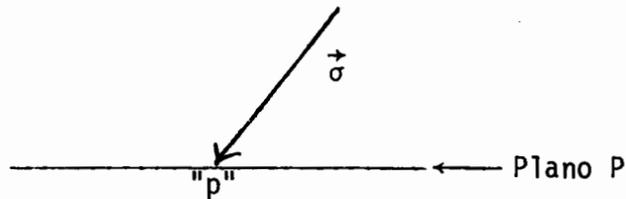
Figura 7. VECTOR DE ESFUERZO ( $\vec{\sigma}$ ) ACTUANDO EN UN PUNTO "p" DE UN PLANO P.
