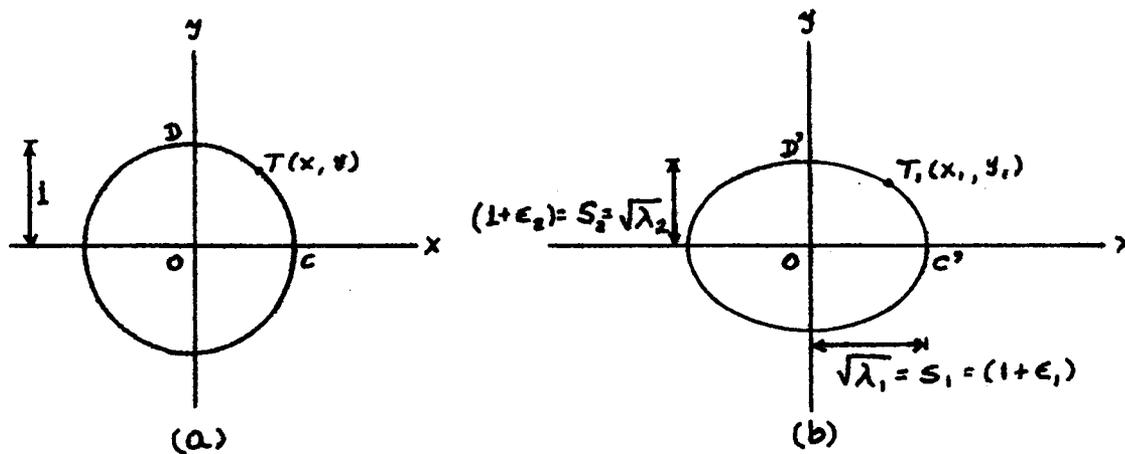
Figura 38. (a) CIRCULO DE RADIO UNITARIO CON CENTRO EN EL ORIGEN; (b) ELIPSE RESULTANTE DE LA DEFORMACION DEL CIRCULO UNITARIO, EL CUAL FUE ACORTADO EN LA DIRECCION DE "Y" y ALARGADO EN LA DIRECCION DE "X".
