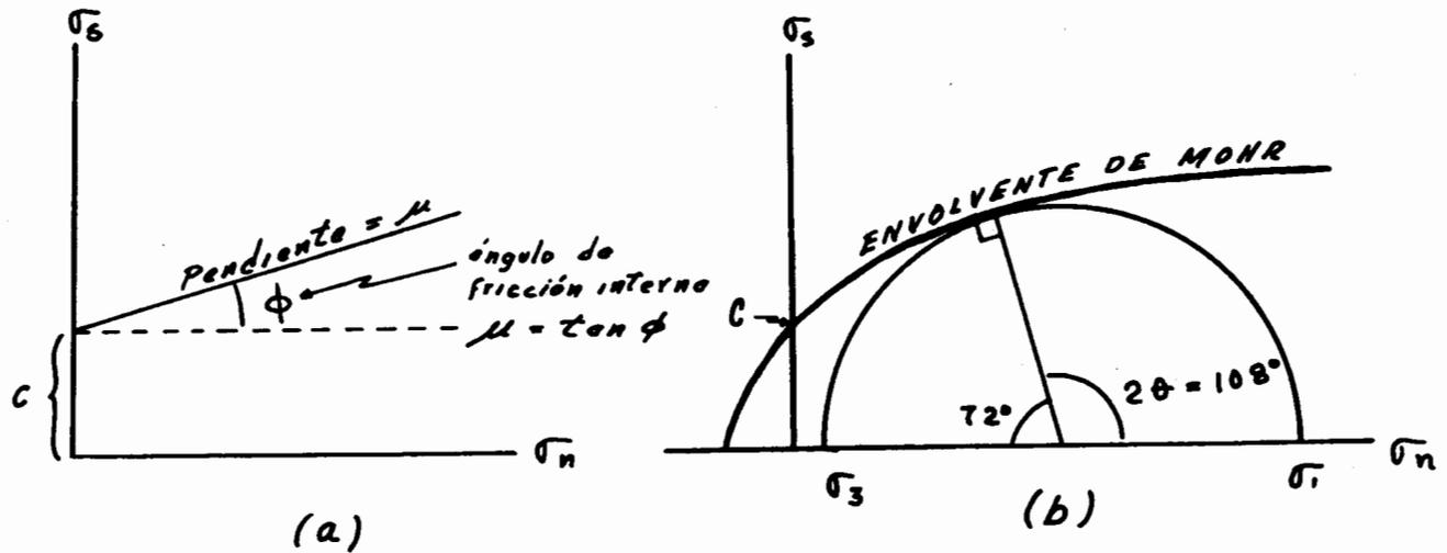
Figura 71. (a) CRITERIO DE COULOMB. (b) EL MISMO CRITERIO, PERO MODIFICADO POR MOHR, EL CUAL UTILIZA UNA CURVA PARABOLICA EN LUGAR DE UNA RECTA PARA DETERMINAR EL COEFICIENTE DE FRICCIÓN INTERNA ( $\mu$ ).
