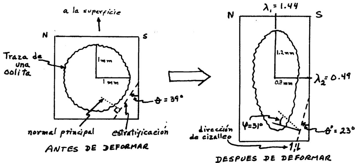
Figura 56. NOTESE QUE LA ESTRATIFICACION NO ES PARALELA A NINGUNA DE LAS DIRECCIONES PRINCIPALES DE DEFORMACION.
