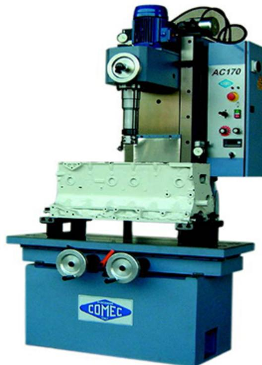
Figura 6. Rectificadora de cilindros. [5]
