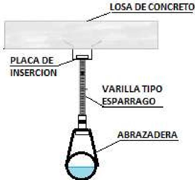
Figura 22. Detalle de agarre de la tubería reubicada, (imagen propia).
