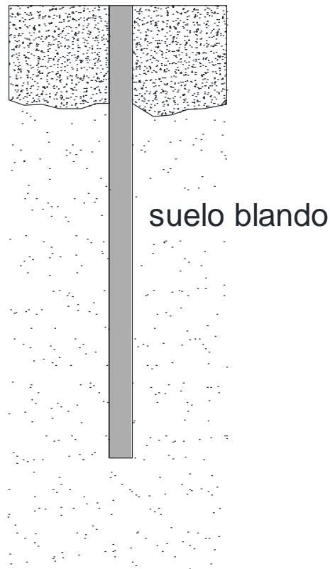
Figura 1.3: Pilotes de fricción. Braja M. (2001).
