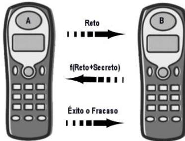
Fig. 2.7 Dispositivo A autenticando dispositivo B
