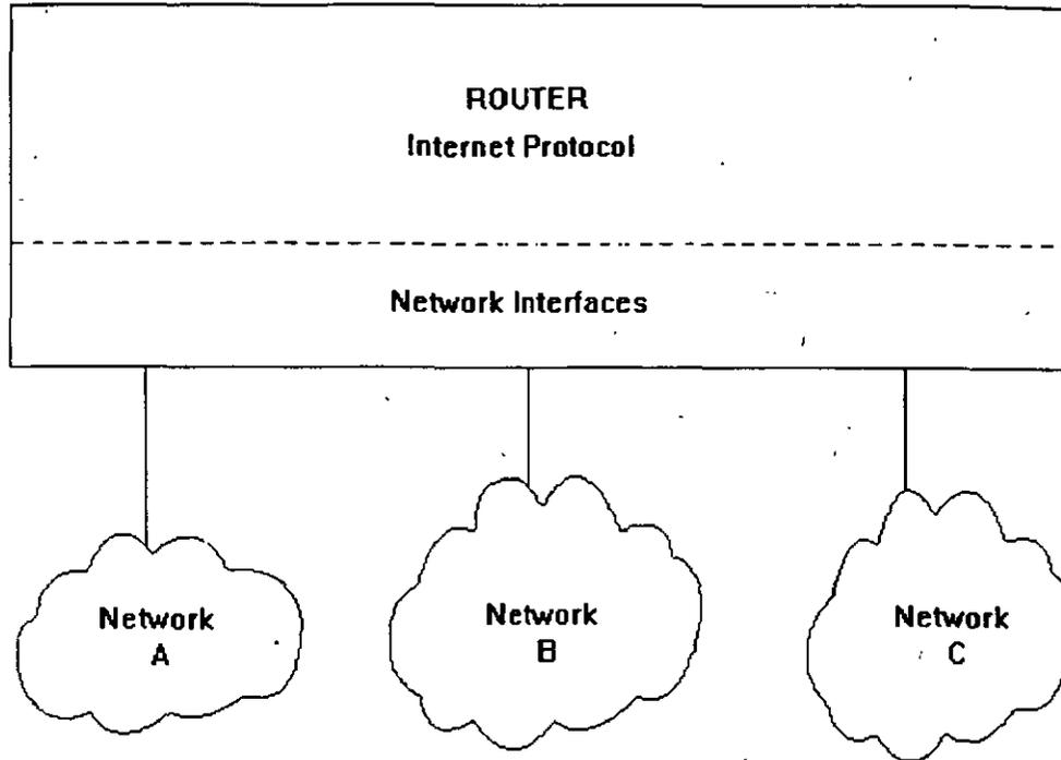
La figura (Fig 2.4), ilustra la arquitectura de protocolo de un *ruteador dedicado*. Debe observarse que no existe la necesidad de TCP debido a que las conexiones de las aplicaciones no inician ni terminan en el ruteador. Es evidente que un ruteador debe estar conectado al menos a dos redes.
