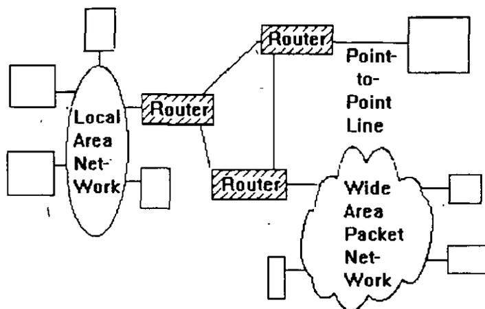
Además de ejecutar software IP, los ruteadores emplean típicamente un segundo protocolo para intercambiar información con otro, acerca de la situación actual de la Inter-Red a la que pertenecen.
