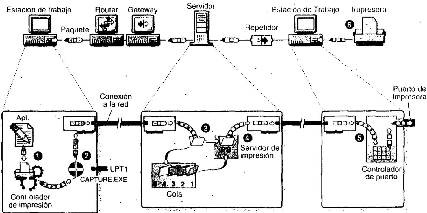
**Paso 1** Se generan y transmiten los datos de impresión.
