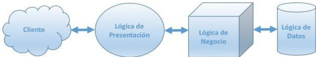
Figura 1. Esquema ilustrativo de la arquitectura cliente-servidor, la cual se divide en lógica de presentación, lógica de negocio, lógica de datos.
