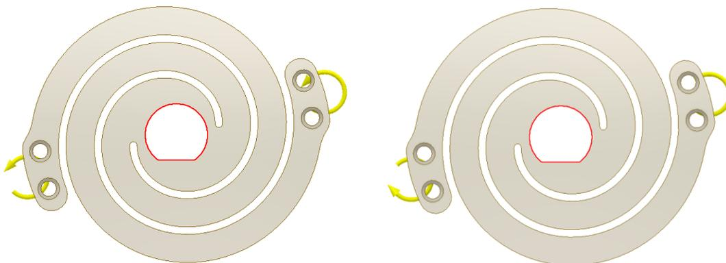
**Figura 4.5** Restricciones y cargas aplicadas para la simulación del análisis de elemento finito. En el centro se fijó y en las pestañas del resorte se aplicó la carga
