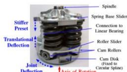
Prótesis para amputaciones a nivel de la rodilla, que trata de replicar los movimientos bilógicos a través de la utilización de un sistema del tipo CSEA (siglas de Clutchable series-elastic actuator). Varía la rigidez para proveer un par específico relacionado con la optimización de la dinámica de tareas particulares.
