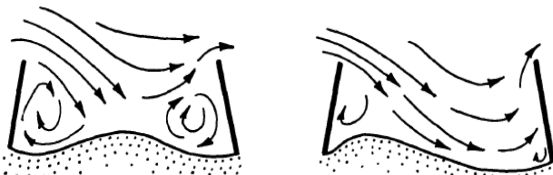
Figura 2.11 Flujo lanzado directamente a la orilla del cauce
