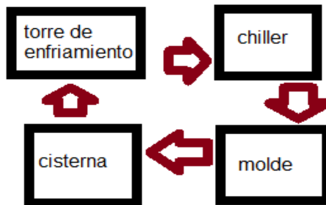
Figura 3.6 Diagrama de bloques del sistema de enfriamiento que se sustituyó en Plásticos Alica S.A de C.V
