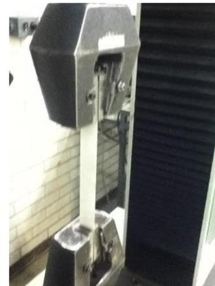
Figura 4.10 Sujeción de la probeta
