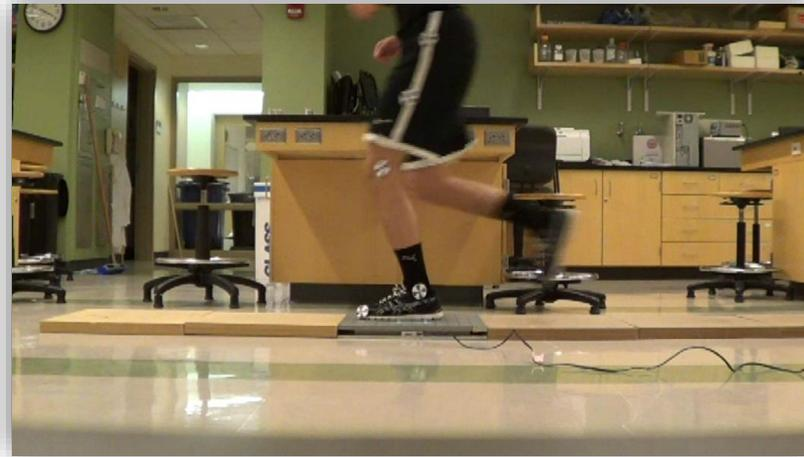
Figura 4.16 Persona trotando en prueba de fuerza en plataforma [17]
