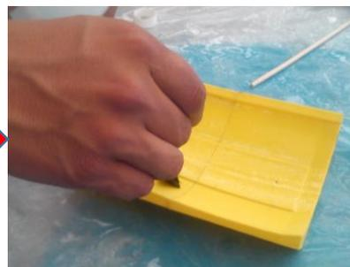
Figura 3.23 Aplicación de película separadora
