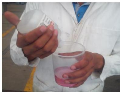
Figura 3.25 Mezcla de resina y catalizador
