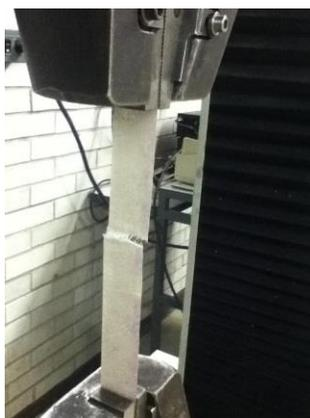
Figura 4.12 Falla de la probeta
