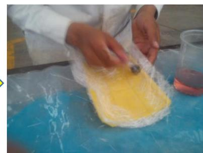
Figura 3.29 Aplicación de la 3ª capa de fibra
