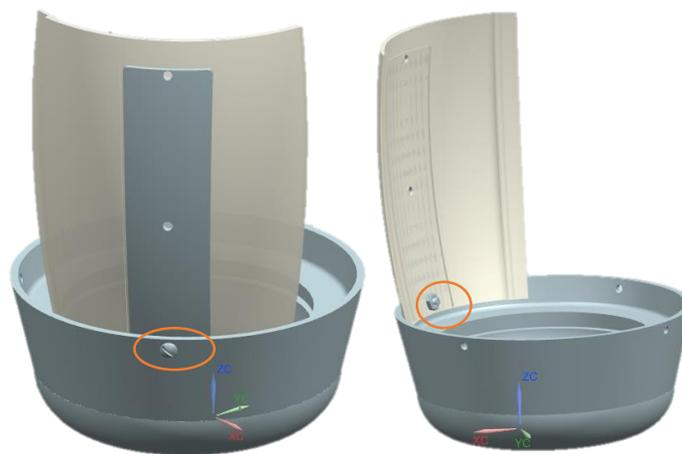
Figura 5.10 Aseguramiento de barras verticales y paredes
