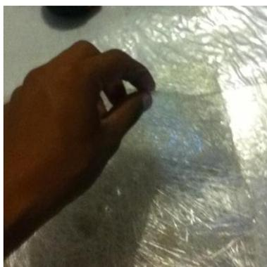
Figura 4.4 Aplicación de nueva capa de fibra
