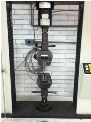
Figura 4.9 Sistema de sujeción
