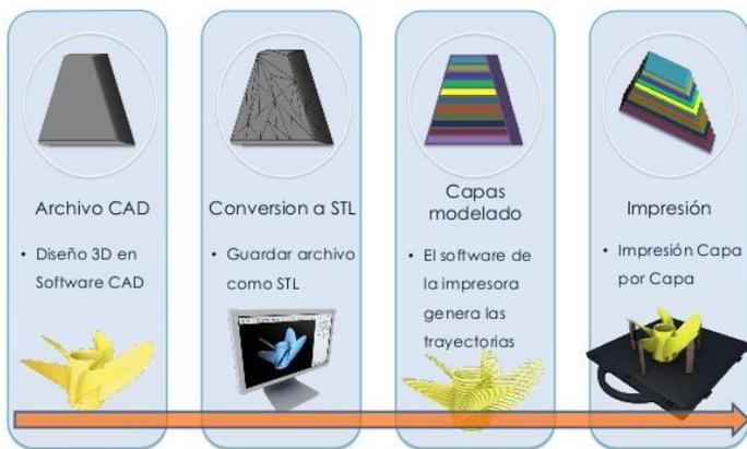
Figura 3.7 Proceso de manufactura aditiva [27]
