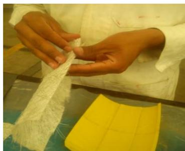
Figura 3.24 Separación en 2 de una hoja de fibra
